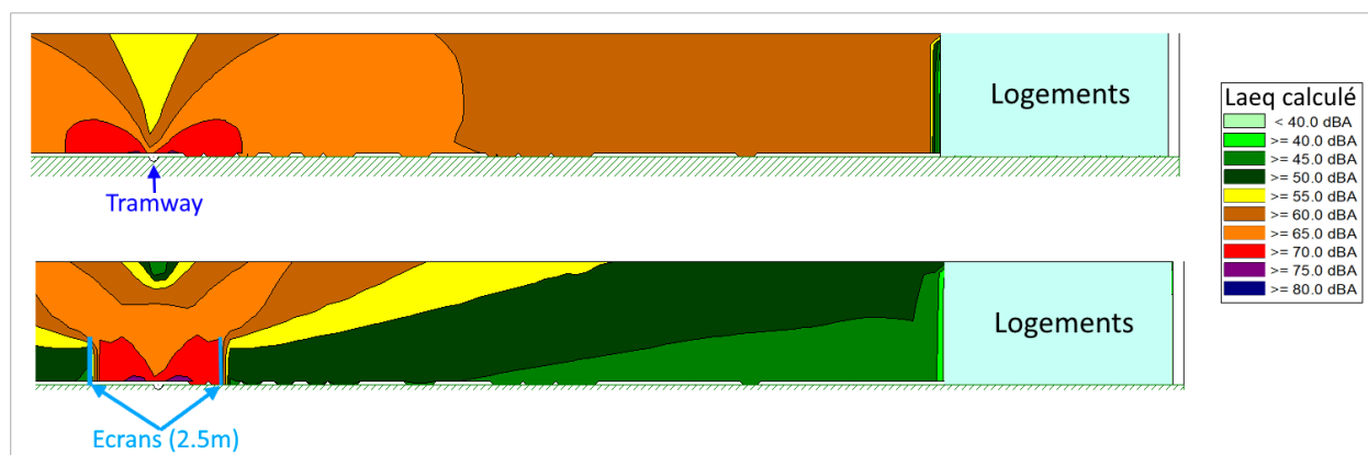
Figure 128 : Illustration des effets d'un écran antibruit de 2,5 m, en coupe verticale
