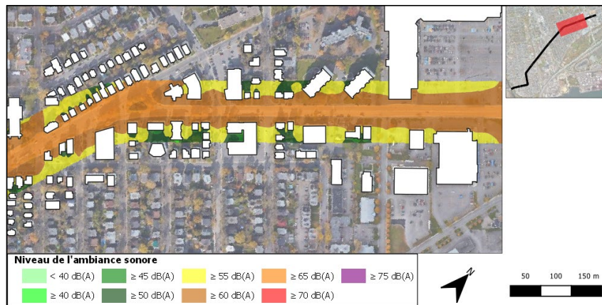
Figure 72 : Cartographie du bruit existant – Secteur du boulevard Sainte-Anne, entre l'intersection du chemin de la Canardière et l'avenue d'Estimauville - Niveau de bruit L_d – Hauteur 4 m
