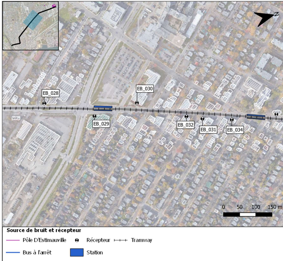
Figure 5 : Sélection des bâtiments représentatifs pour l'étude acoustique détaillée au niveau du chemin de la Canardière, entre le boulevard Henri-Bourassa et le boulevard Sainte-Anne
