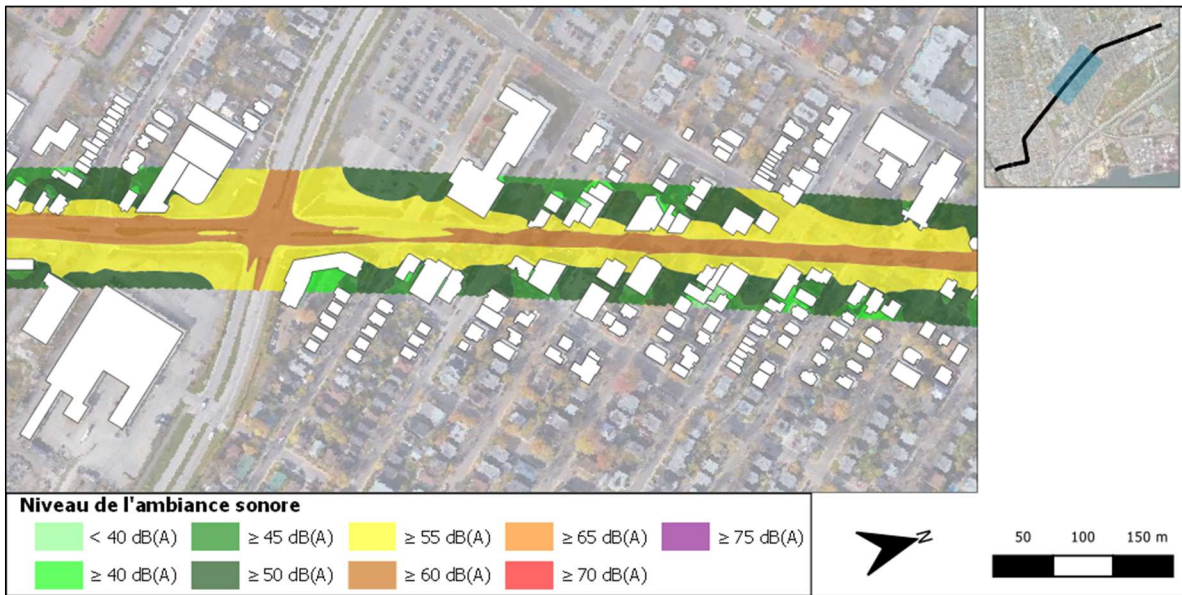
Figure 21 : Cartographie du bruit existant – Secteur du chemin de la Canardière, entre le boulevard Henri-Bourassa et le boulevard Sainte-Anne - Niveau de bruit en période nocturne L_n – Hauteur 4m
