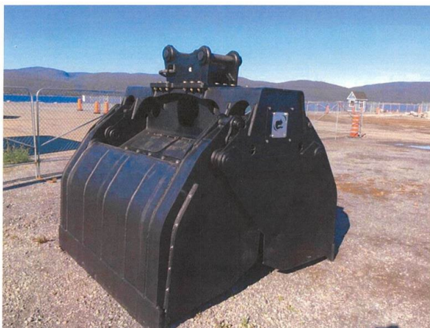
Figure 4.4.11 : Exemple d'une benne environnementale (Level Cut)
