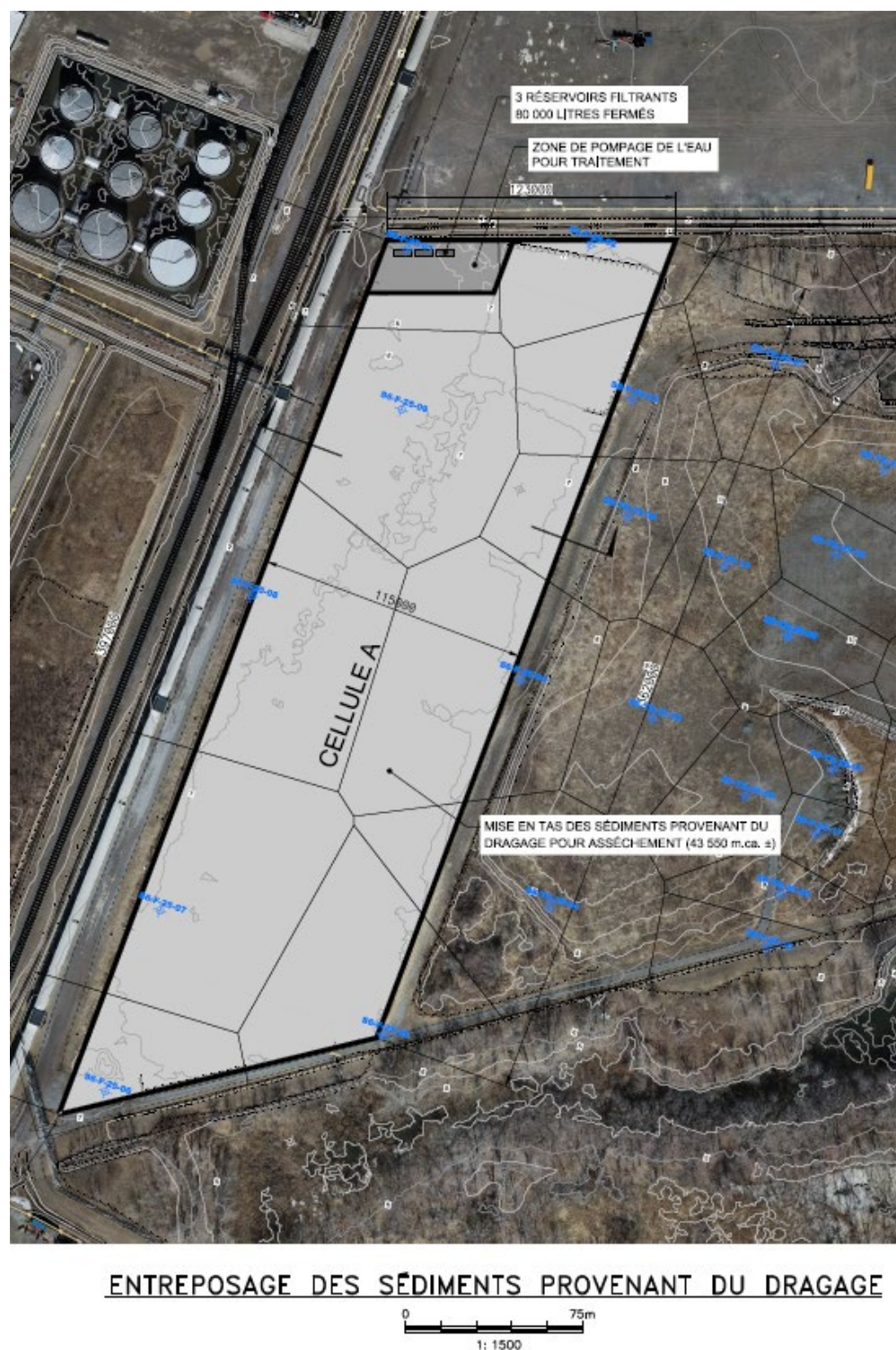
Figure 4.6.1 : Composantes de l'aire d'assèchement préliminaire (cellule A) et emplacement des puits souterrains
