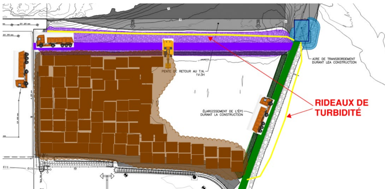
Figure 4.6.10 : Localisation de rideaux de turbidité dans le bassin d'entreposage en arrière du quai B6
