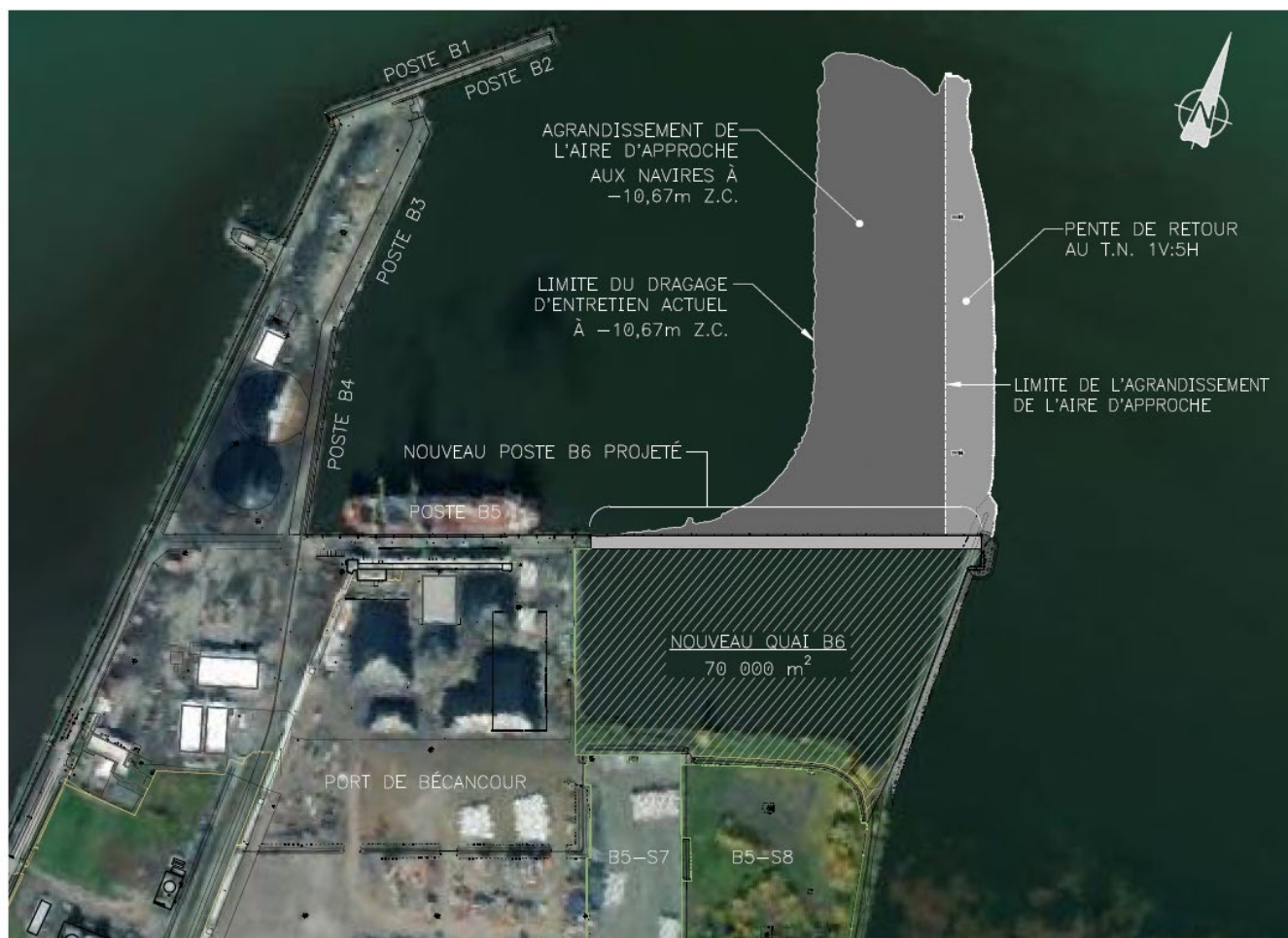
Figure 4.3.1 : Principaux éléments du futur quai B6
