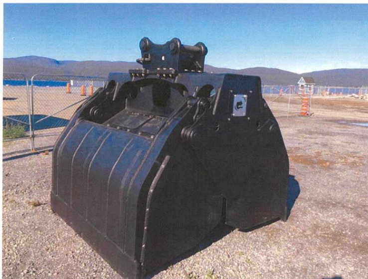
Figure 4.4.10 : Exemple d'une benne environnementale (« levelcut »)
