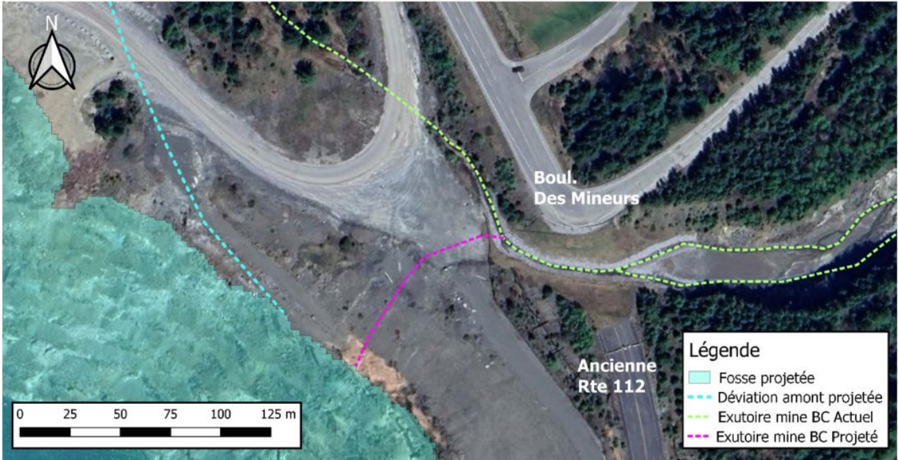
Figure 2. Tracé actuel (vert) et déviation proposée (rose) pour l'exutoire de la mine BC (Avizo 2024).
