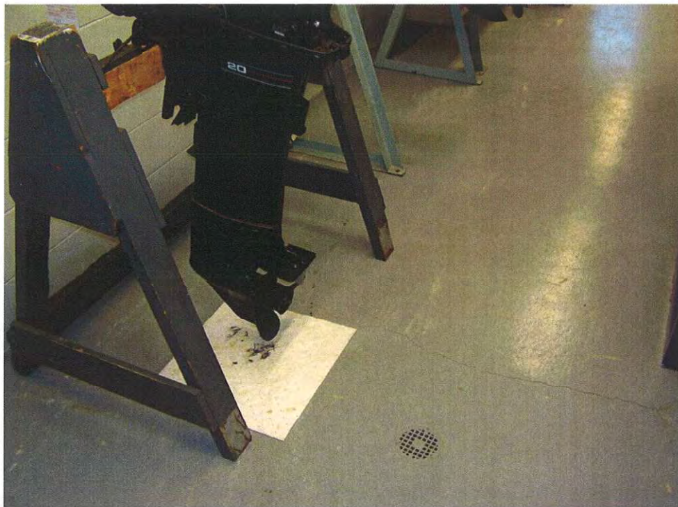
Photo n° 5. Linge absorbant utilisé par la réserve navale pour les déversements mineurs d'huile à moteur
