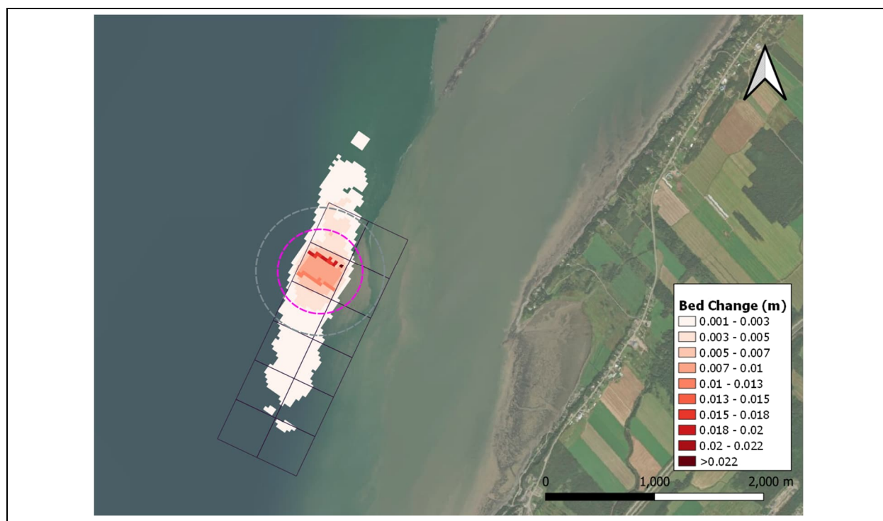
Figure 27 Dépôt de sédiments entre le 21 septembre et le 8 décembre autour de la cellule de dépôt 2025
