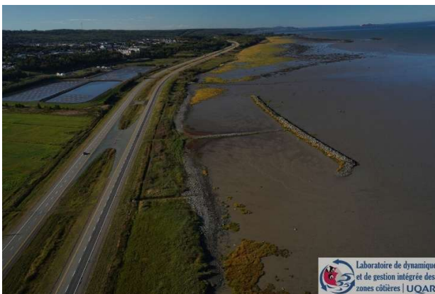
Figure 3-5 : Exemple d'un brise-lames attaché aménagé au site G0201 à Rivière-du-Loup, dans le secteur du Bas-Saint-Laurent
