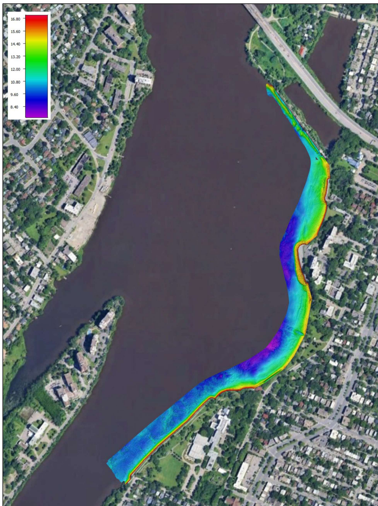
Figure 2 Couverture réalisée lors du levé bathymétrique (Hydro-Québec 2026)
