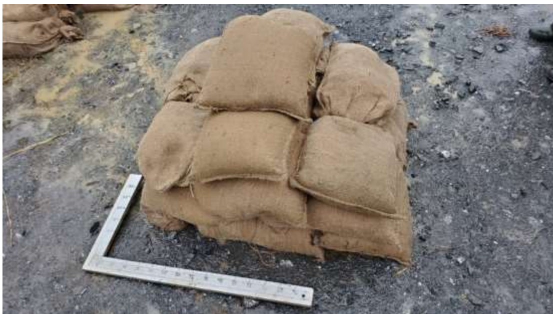
Figure 4.1 Exemple de positionnement des sacs de sable sur un projectile
