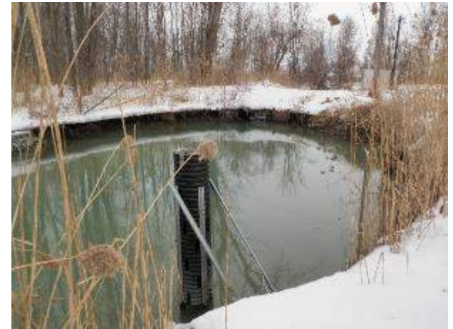
Cylindre de pvc protégeant la sonde multi-paramètres mobile avec dispositif de flotteur Stations du Six et Dix-huit arpents
