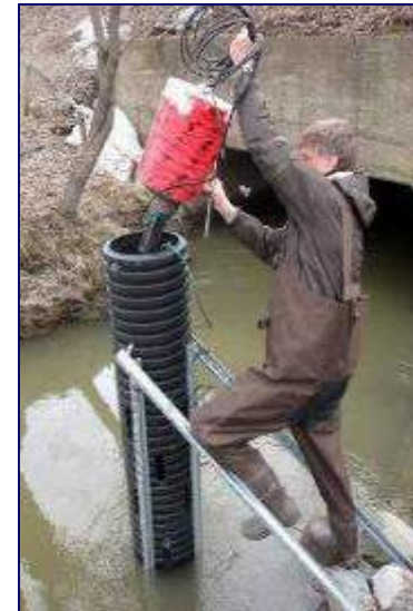
Cylindre de pvc protégeant la sonde multi-paramètres mobile avec dispositif de flotteur Stations du Six et Dix-huit arpents
