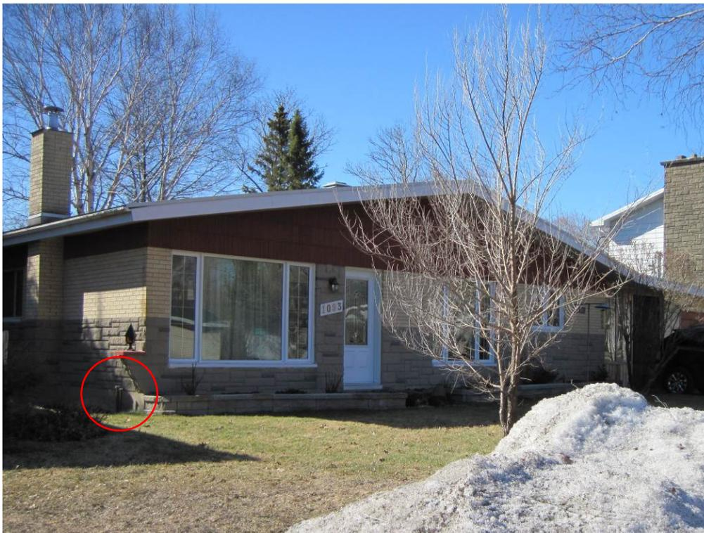
Photo 2 Tuyau de remplissage et évent d'un réservoir d'huile à chauffage sur le côté de la résidence occupant le lot 1 313 064. Vue en direction sud.
