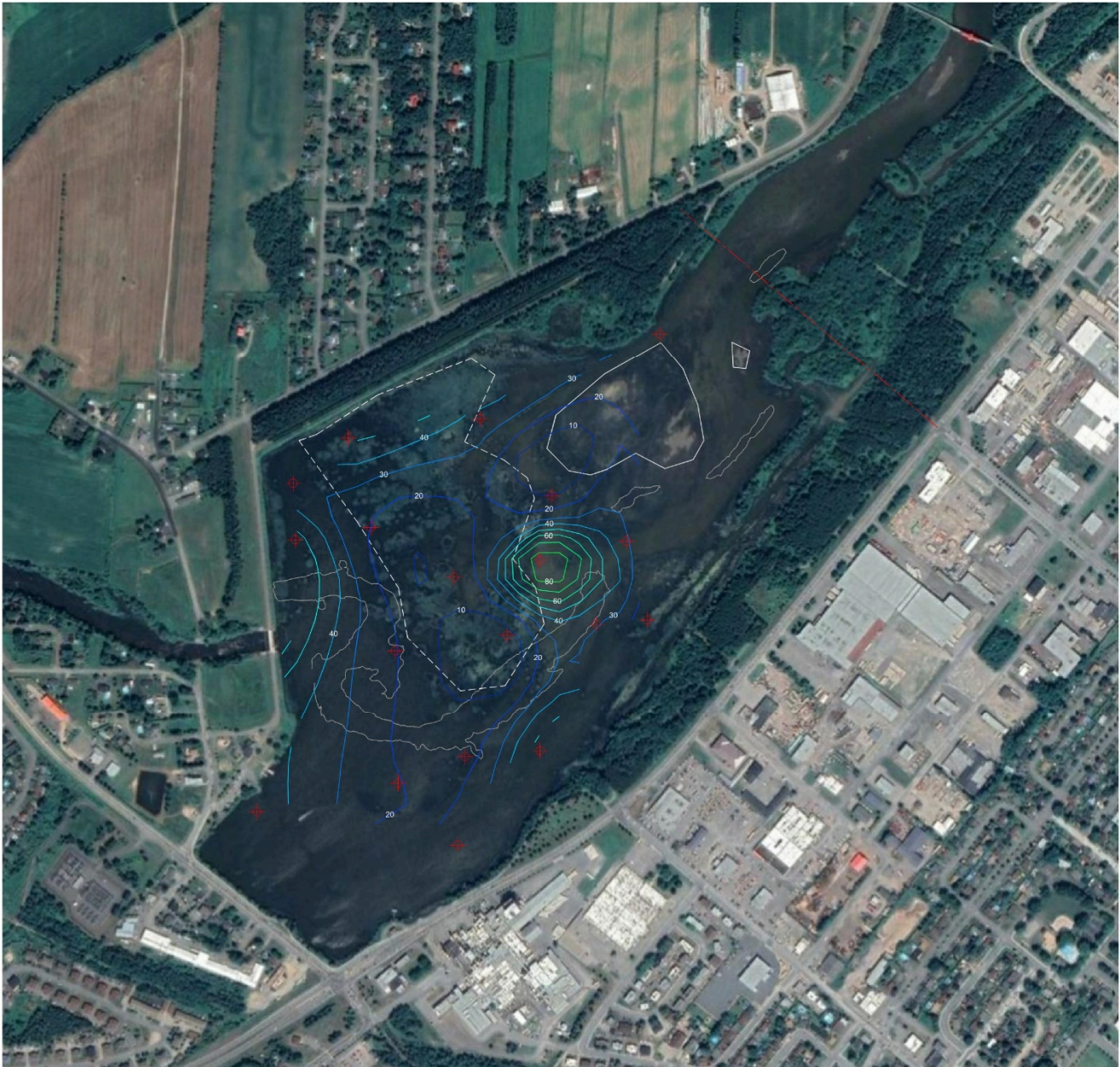
Figure 3.3 : Analyse des dépôts de sable et gravier dans le réservoir Beaudet (source : Smi)
