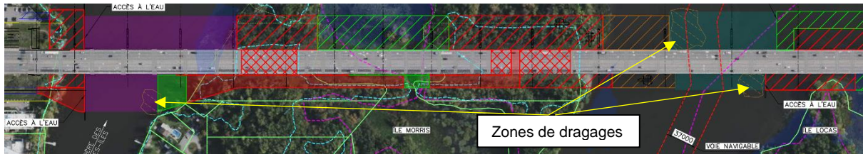
Figure 2-29 Zones de dragages des accès par barges
