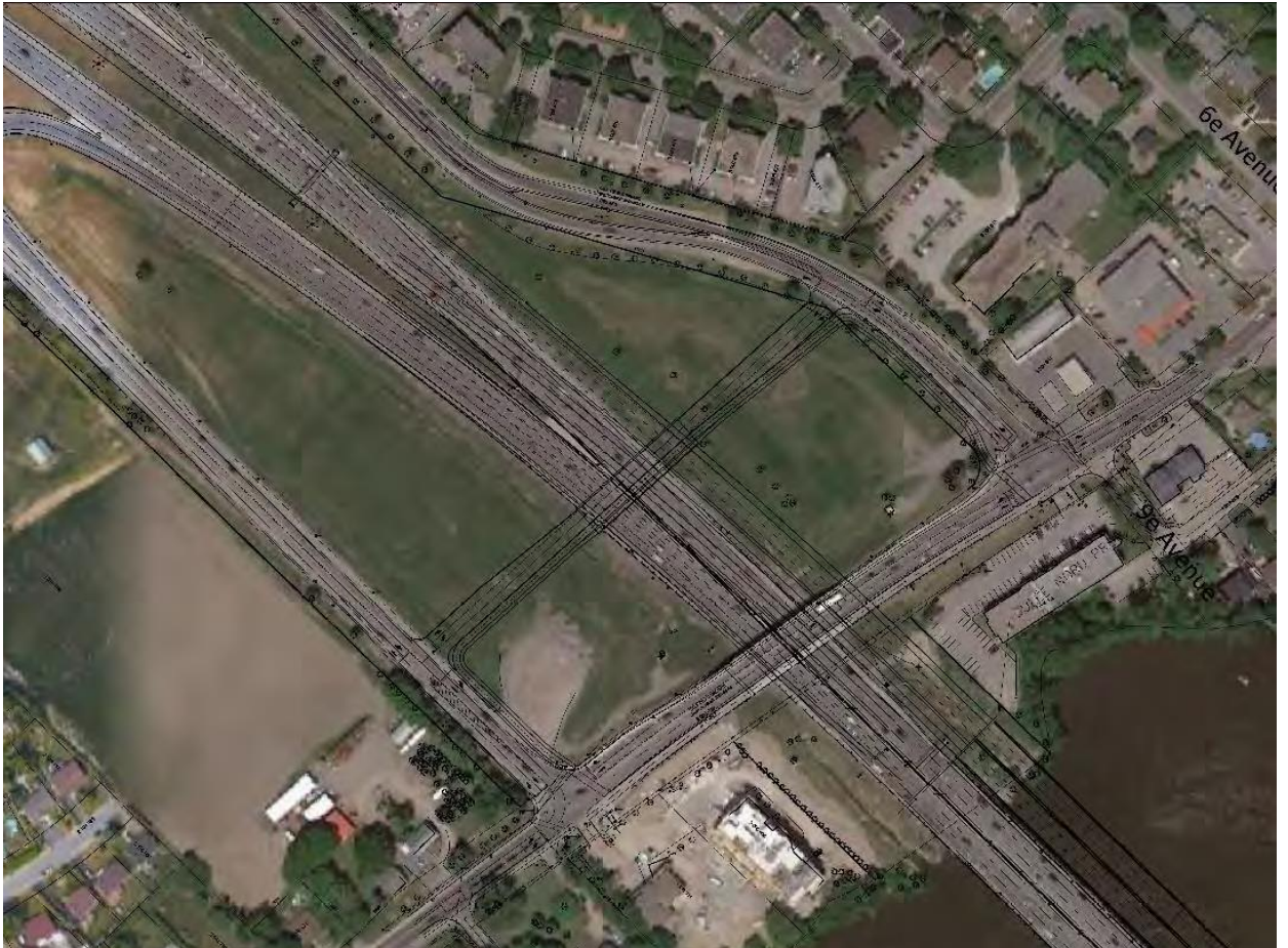
Figure 5-16 Déviation temporaire de la R-344 - chemin de contournement
