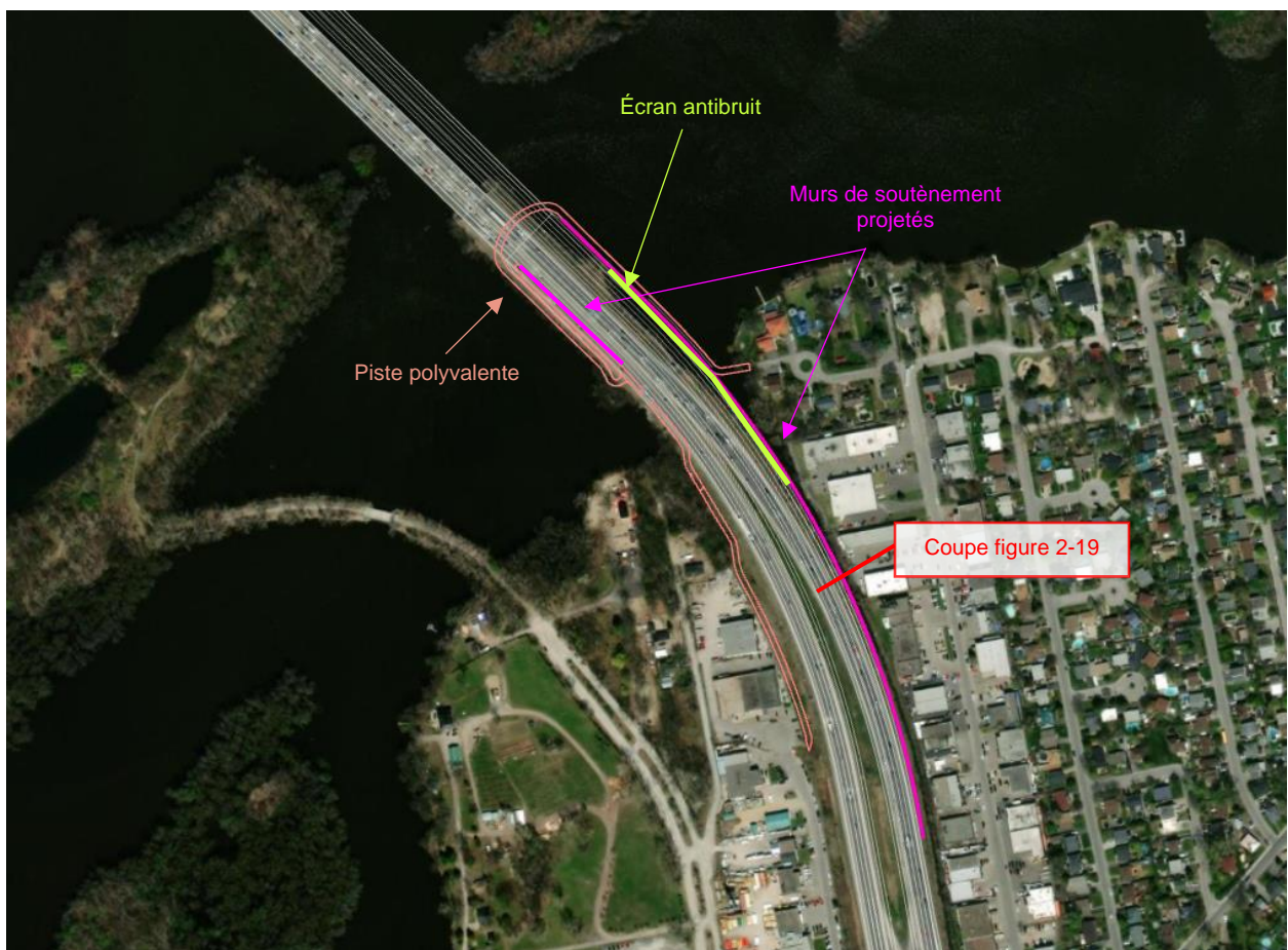
Figure 2-18 Localisation projetée des murs de soutènement
