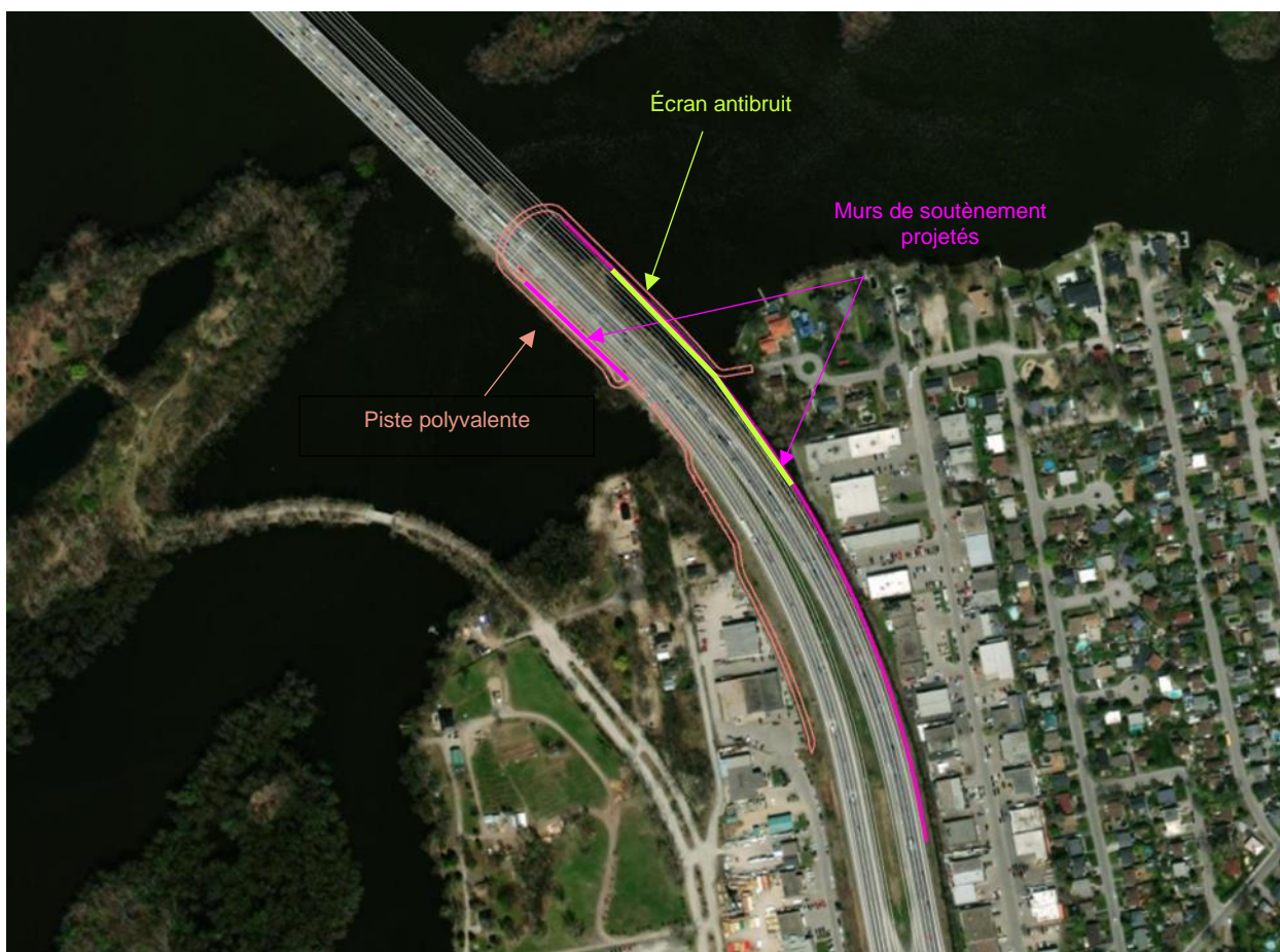
Figure 6.13 : Localisation projetée des murs de soutènement
