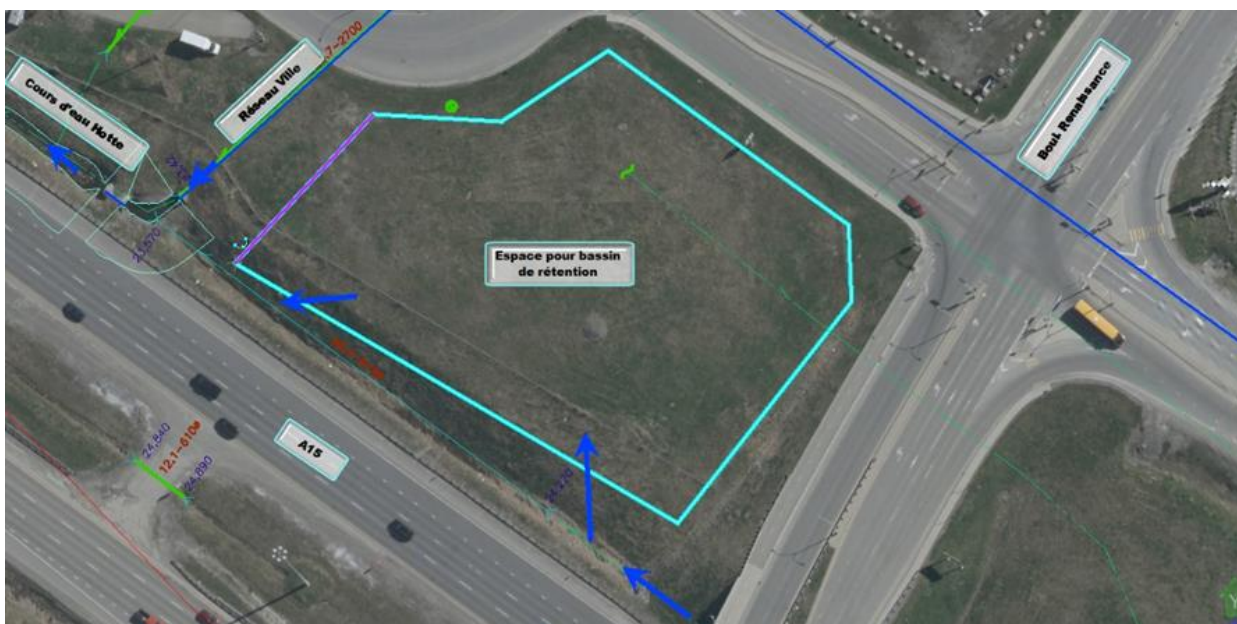
Figure 6.7 : Localisation du bassin de rétention à retenue permanente de l'approche sud
