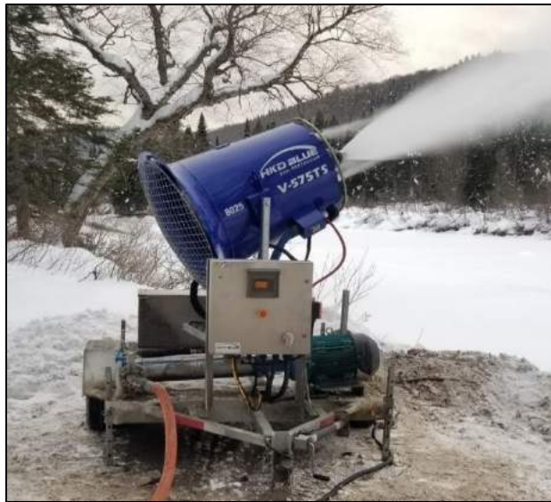
Figure 4. Canon à neige utilisé pour créer un seuil neigeux (Ville de Saint-Raymond, 2017)
