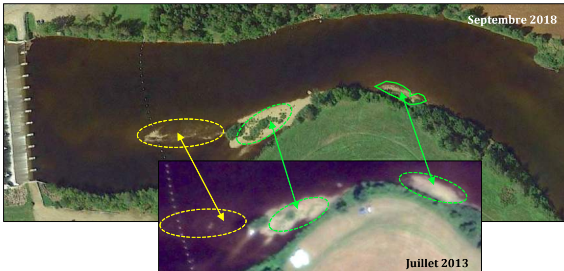
Figure 3: Aggradation de la presqu'île vers l'aval, et implantation des arbustes, entre 2013 et 2018.
