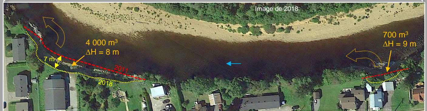
Érosion et transport vers l'aval de matériel entre 2011 et 2018. Arrêt des apports riverains par stabilisation en octobre 2018.
