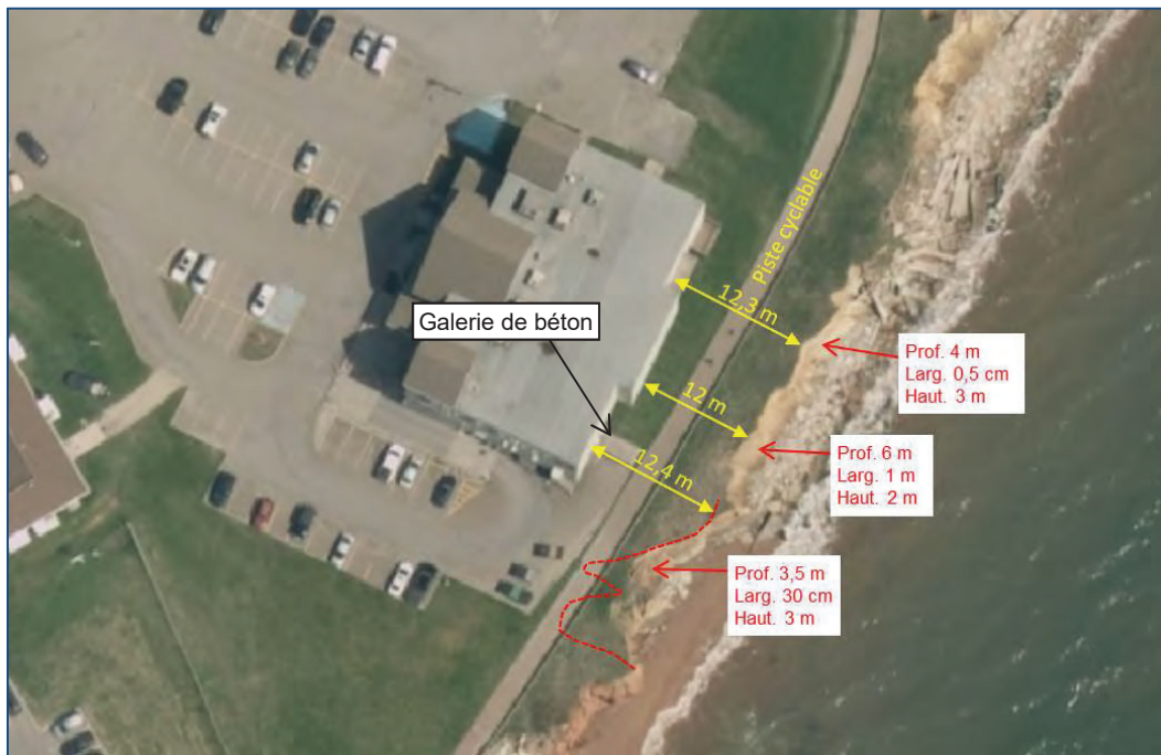
Figure 2. Localisation et dimensions approximatives des grottes les plus profondes. La distance entre le bâtiment et le sommet de la falaise est également indiquée sur la figure.
