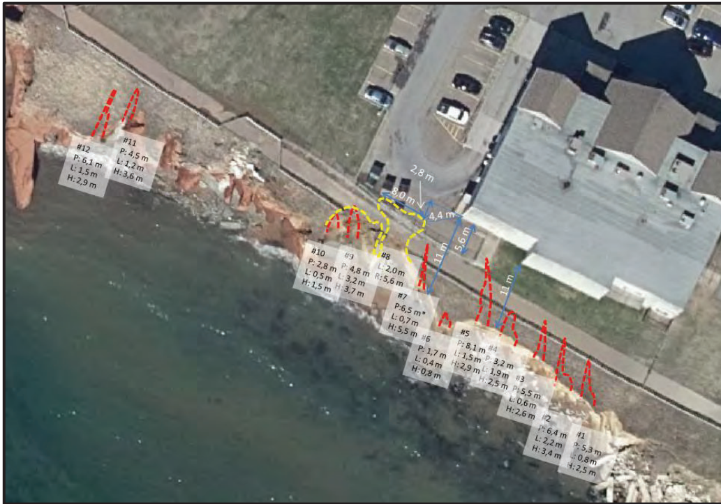
Figure 2. Localisation et dimensions approximatives des grottes (lignes rouges) et des effondrements (lignes jaunes). Les dimensions dans les encadrés sont notées comme suit : p = profondeur de la grotte, L= largeur maximale entre les parois de la grotte et H= hauteur maximale de l'ouverture.
