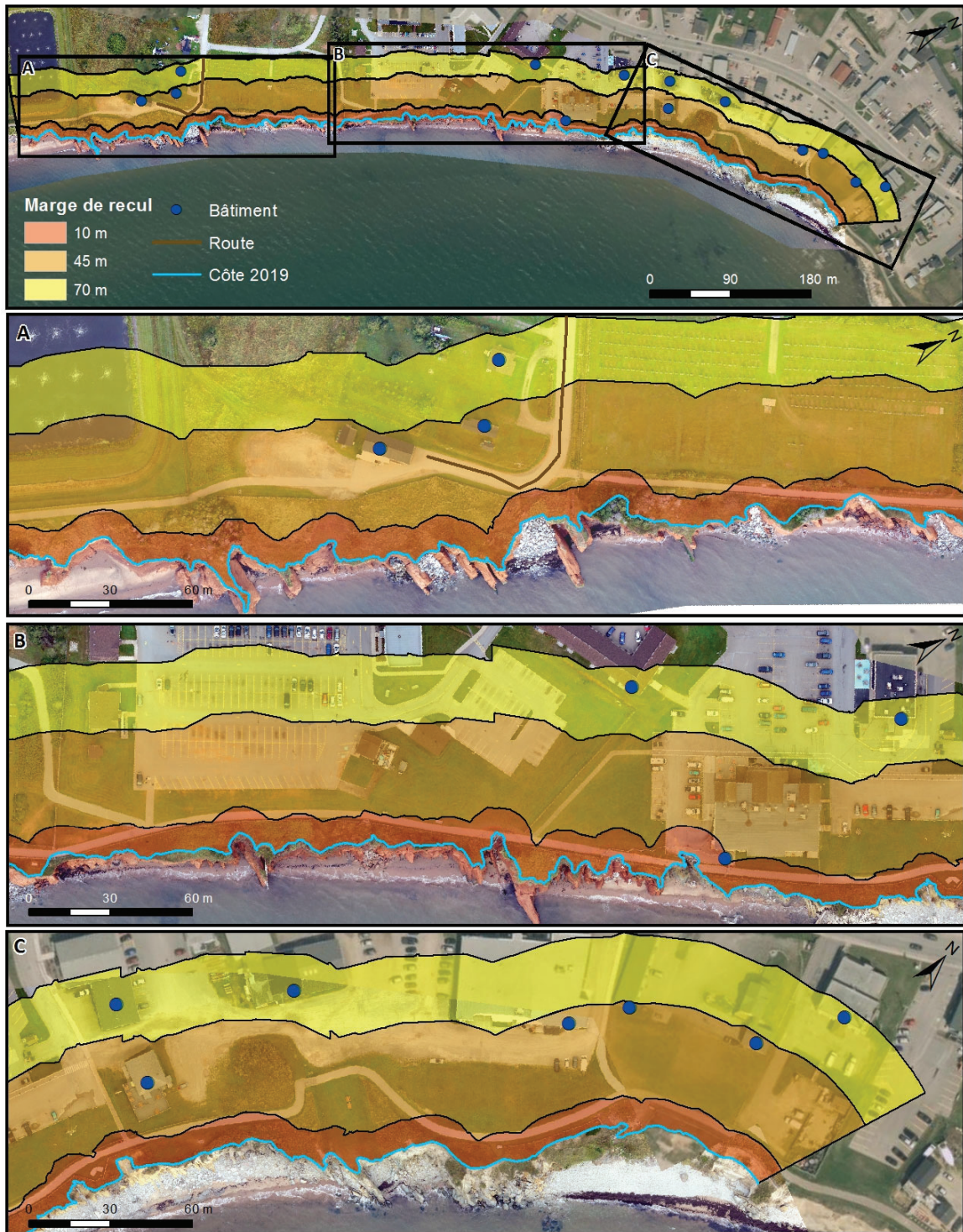
Figure 8. Trois marges de recul dans la zone des travaux
