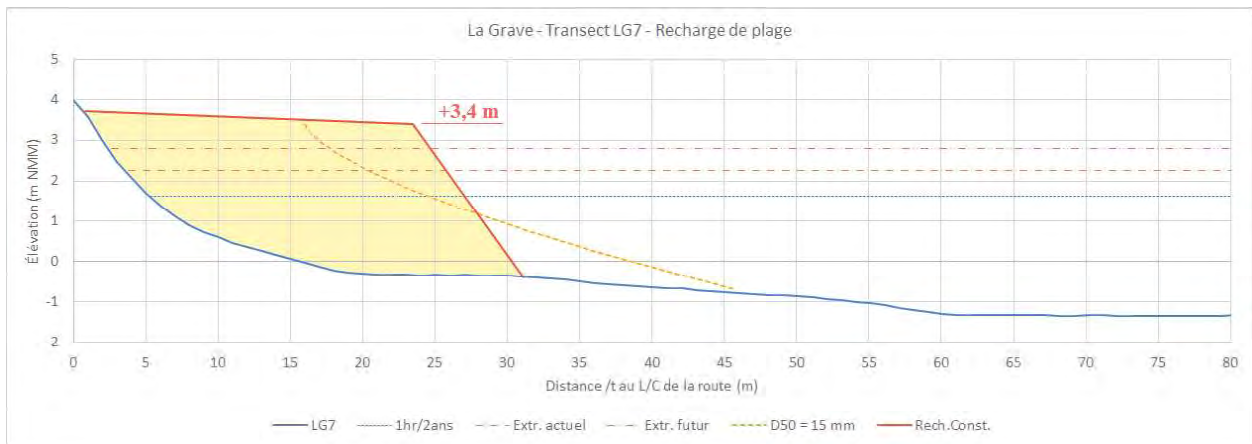
Figure A.7 Coupe de la recharge de plage proposée au transect LG7
