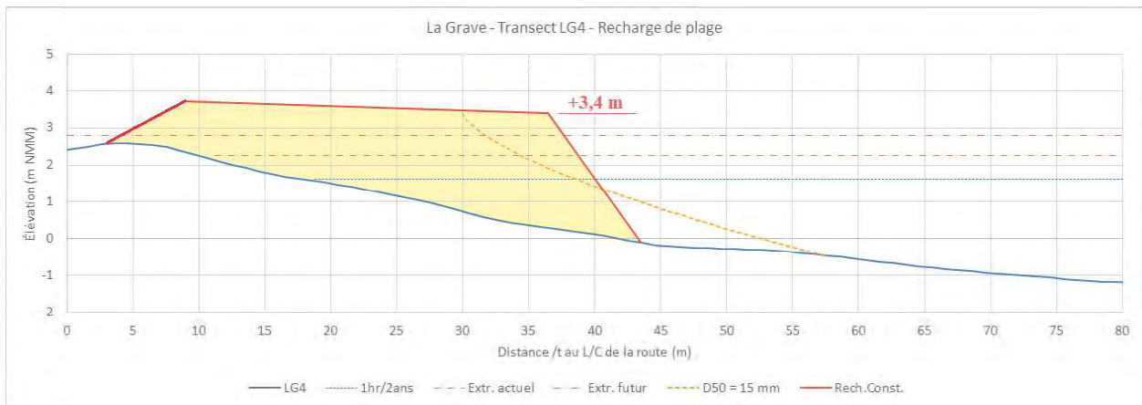
Figure A.4 Coupe de la recharge de plage proposée au transect LG4
