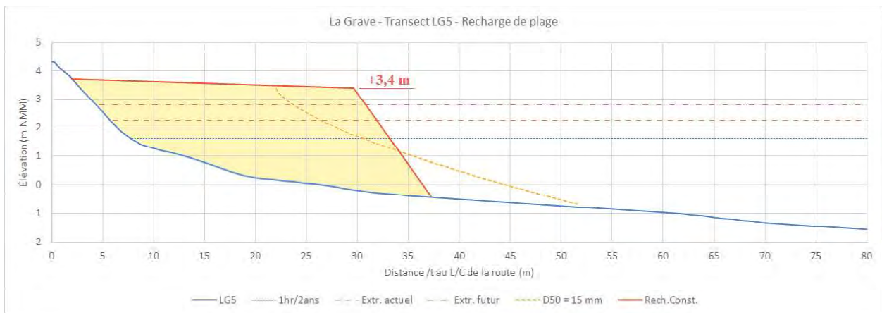
Figure A.5 Coupe de la recharge de plage proposée au transect LG5
