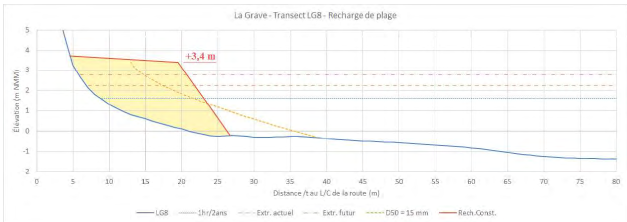
Figure A.8 Coupe de la recharge de plage proposée au transect LG8
