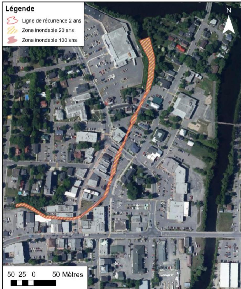
**Figure 4. Cartographie des zones inondables du centre-ville de Coaticook avec aménagement du bassin de rétention et aménagement de murets ( $25 \text{ m}^3/\text{s}$ )**
