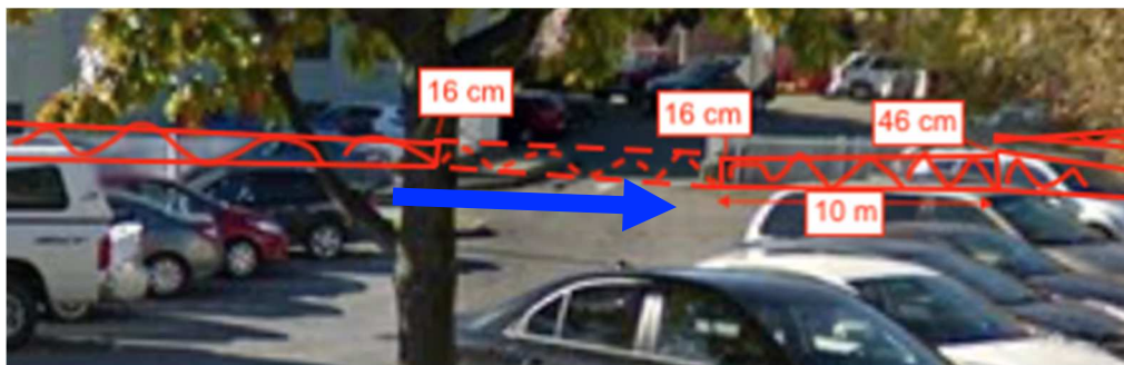
Figure 11 : Croquis des hauteurs requises sur le côté droit de la passerelle de la Caisse Populaire
