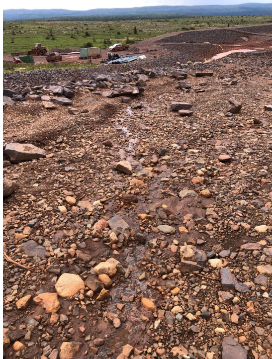
Photo 9 : Écoulement au pied de la halde à stérile, coin est, vers le fossé en aval
