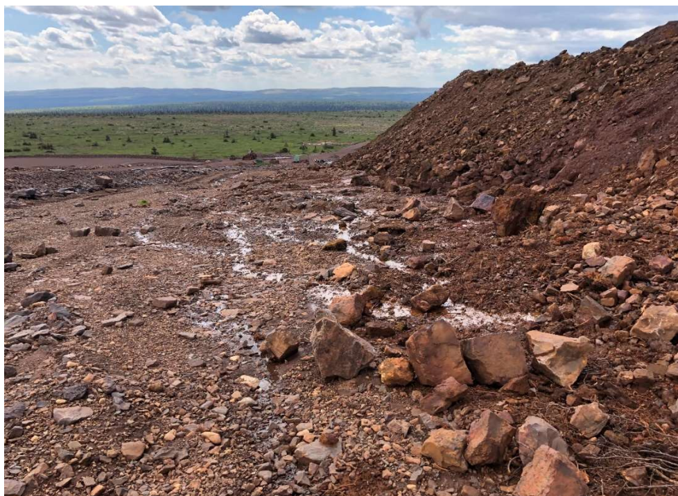
Photo 10 : Écoulement au pied de la halde à stérile, coin est.
