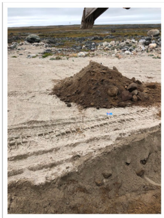
PHOTO 7 — Vue du puits d'exploration PU-20-01 composé de matériaux de remblai et réalisé dans l'emprise du chemin d'accès présent sur le Site (3 septembre 2020).
