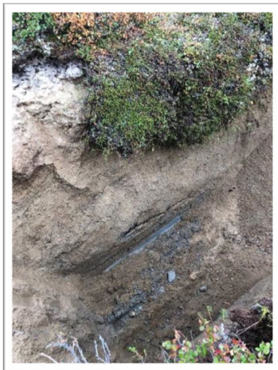
PHOTO 6 — Vue du puits d'exploration PU-20-31 et du refus sur roc ou sur le pergélisol à 2,60 m de profondeur (1 er septembre 2020)
