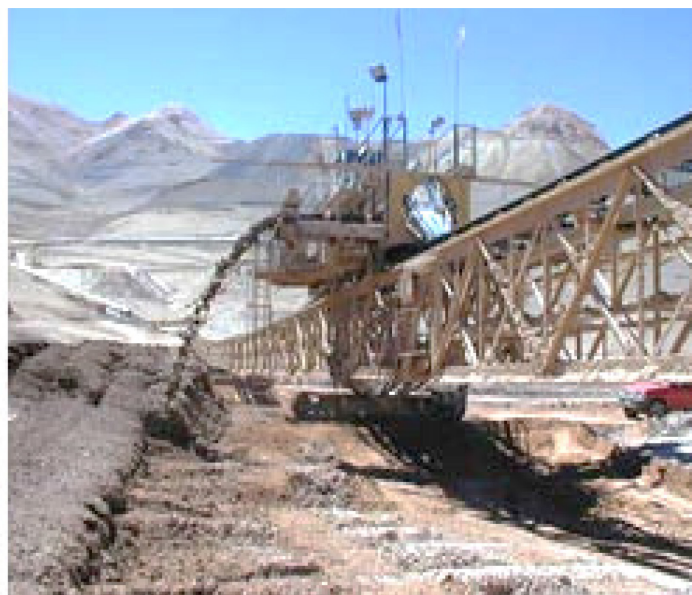
Photo 8 : Parc à résidus filtrés (Projet La Coipa, Mines Anglo American/Debswana) (Engels, S.D.)
