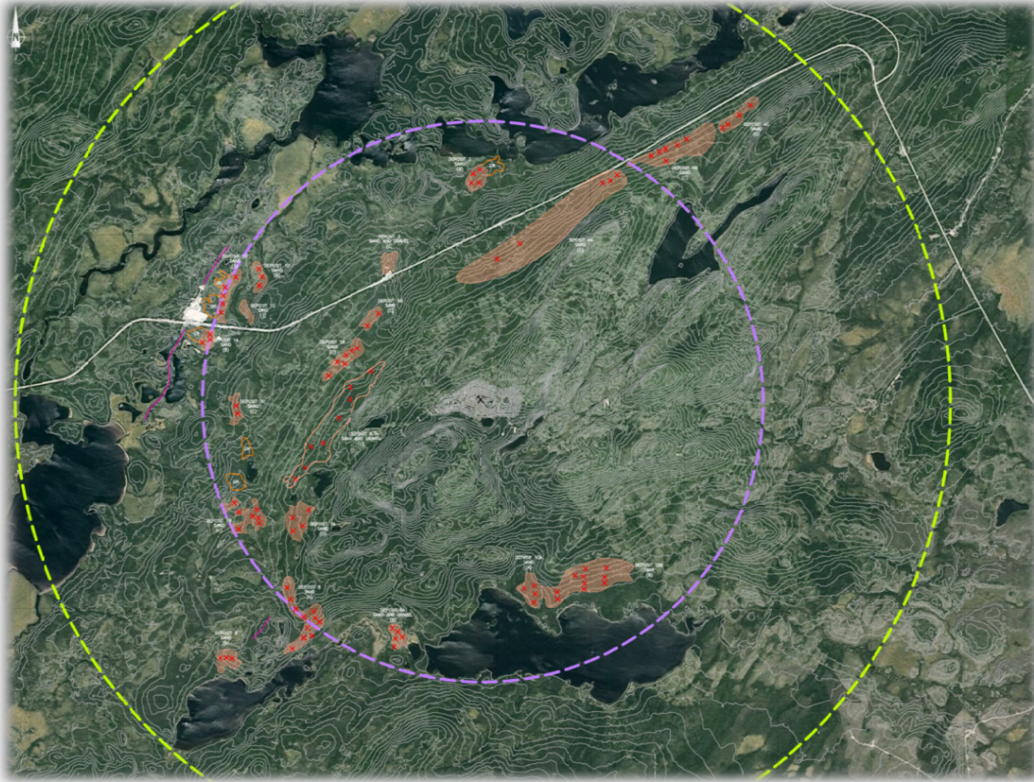
Figure 8-13 : Localisation générale des bancs d'emprunt préliminaires (EXP, 2019)
