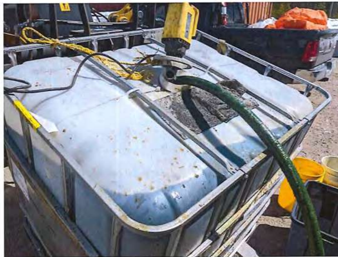
Photo 1 : Boyau débouffé de la pompe
