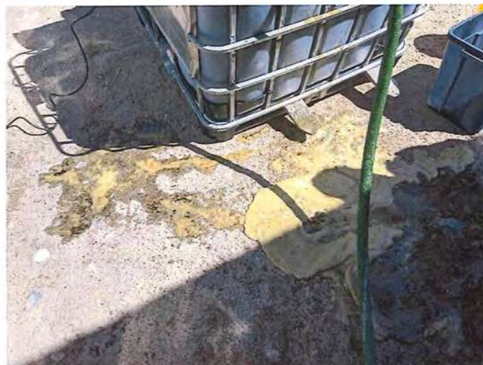
Photo 2: sulfate ferrique réagissant avec le sel de déglacage sur le sol
