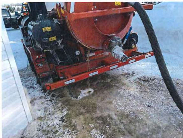
Photo 2: Gros plan sur le joint d'étanchéité qui est sorti de ses gonds
