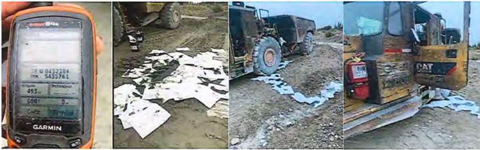
Nettoyage huile hydraulique avec des absorbants granulés
