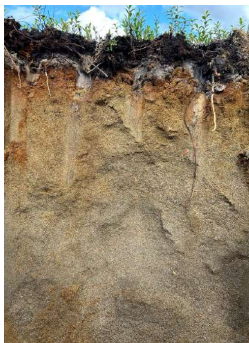
Figure 6-6 : Stratigraphie des sols (TR-7)
