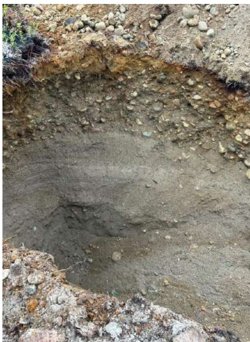
Figure 6-3 : Stratigraphie des sols (TR-4)
