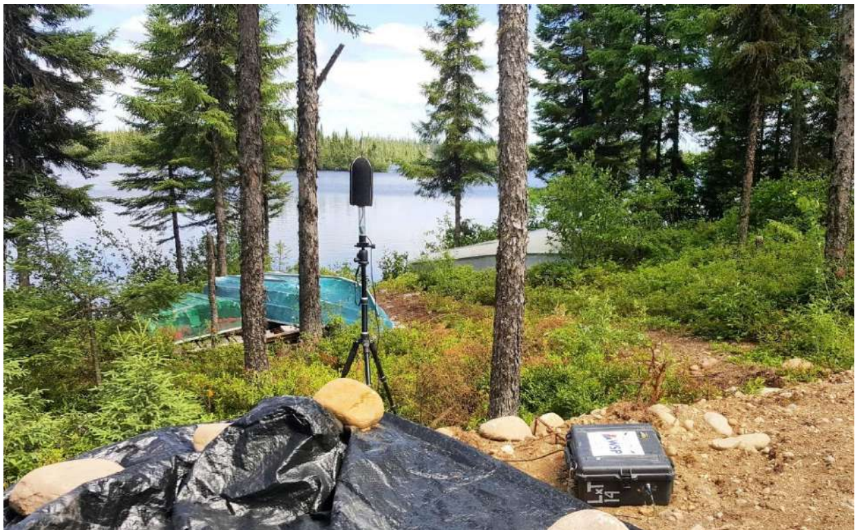
Photo A-2 : Station de mesure installée au point récepteur P2 (camp allochtone)
