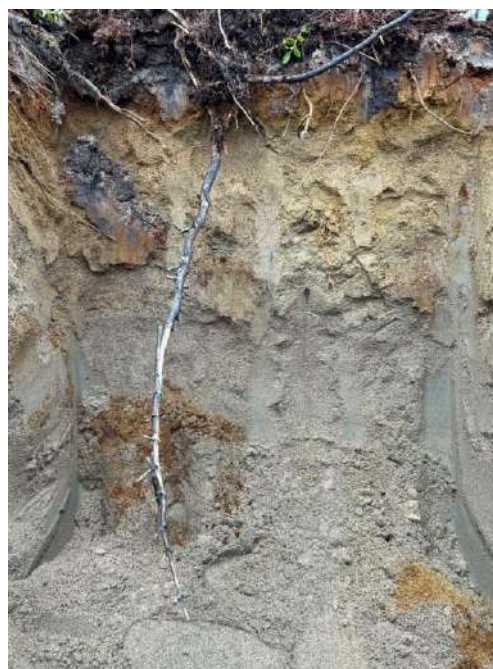
Figure 6-8 : Stratigraphie des sols (TR-9)
