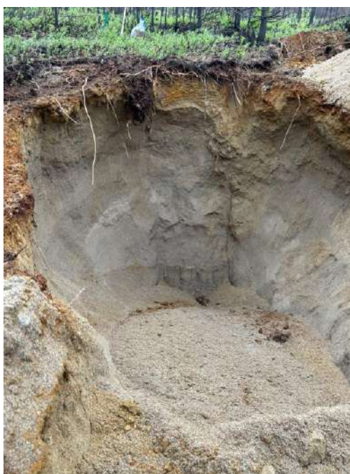
Figure 6-9 : Stratigraphie des sols (TR-10)
