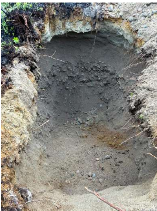
Figure 6-1 : Stratigraphie des sols (TR-1)
