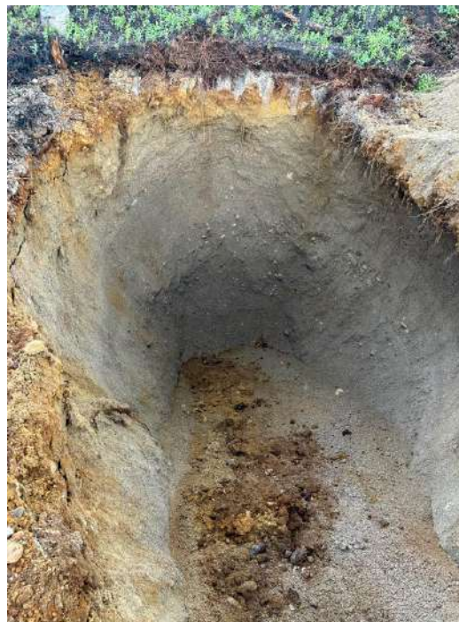
Figure 6-12 : Stratigraphie des sols (TR-15)
