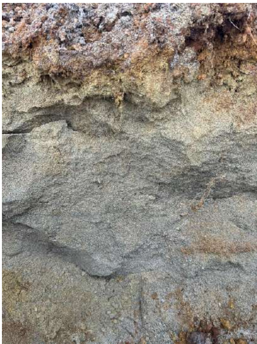
Figure 6-11 : Stratigraphie des sols (TR-14)
