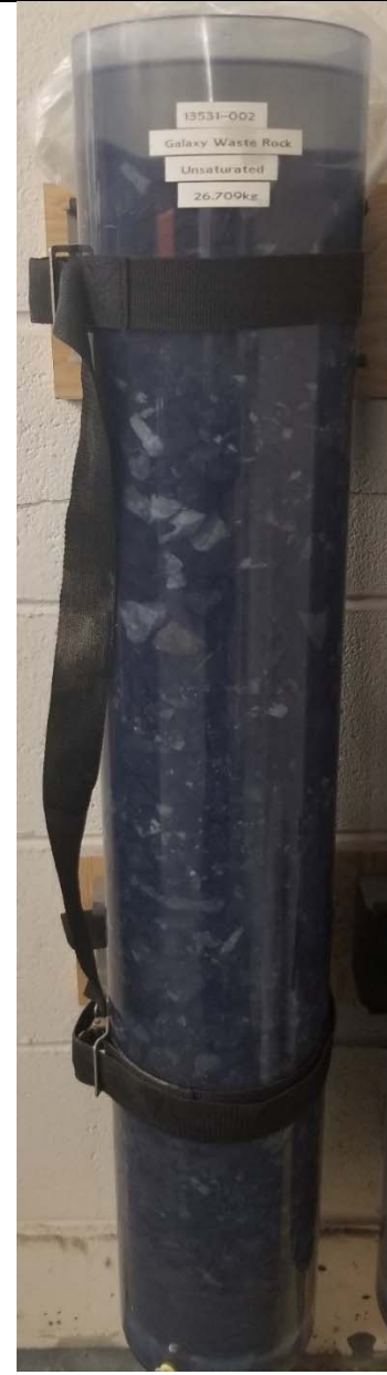
Photo 3 : Colonne n° 3. Stériles non saturés (photo prise lors d'un rinçage)
