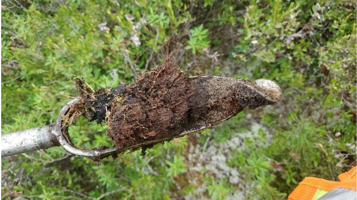
Photo 11 Sols récupérés à l'aide de la tarière manuelle au sondage 20-SM-30-50-1.
