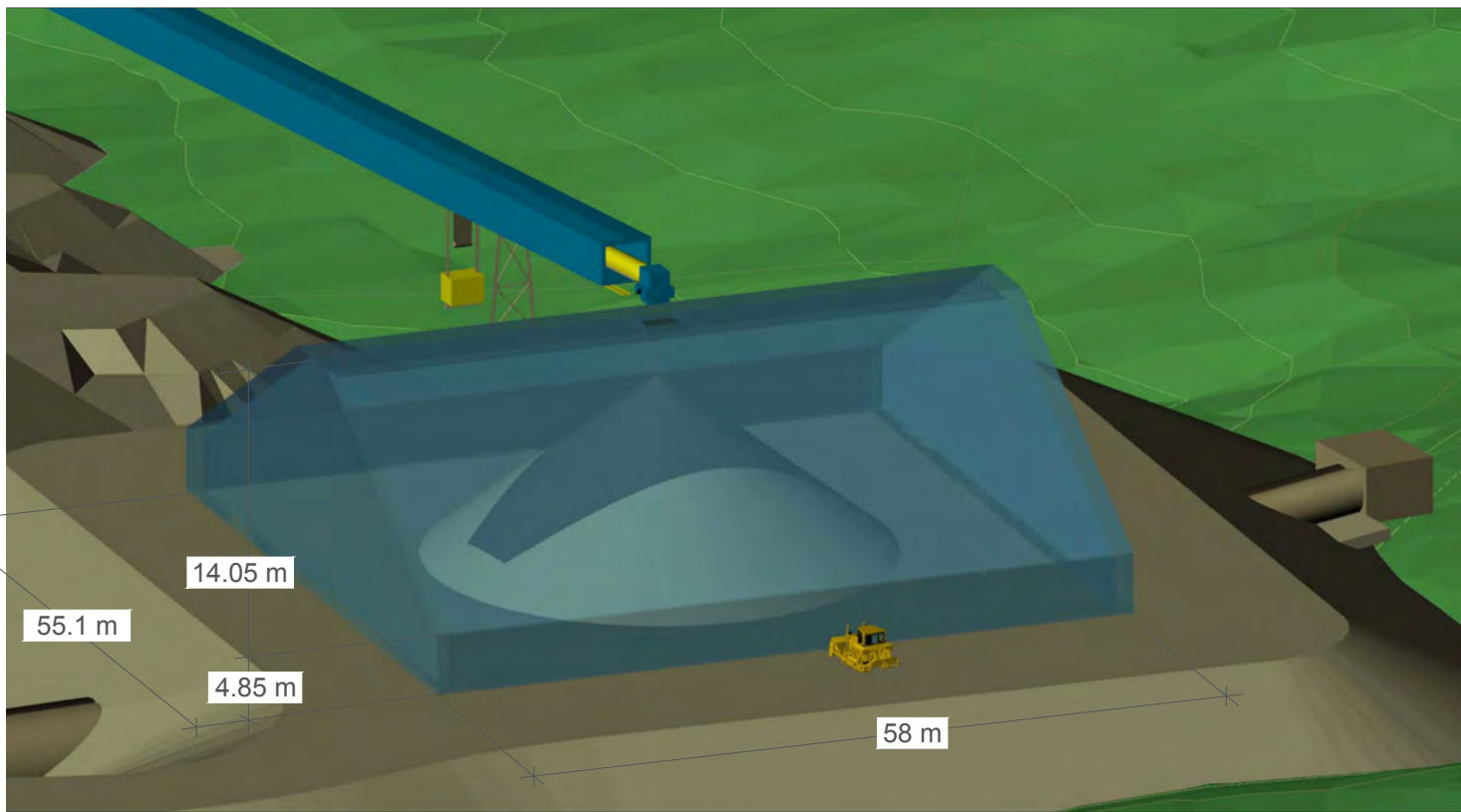
VUE ISOMÉTRIQUE BÂTIMENT PILE TAMPON ÉCHELLE= AUCUNE
