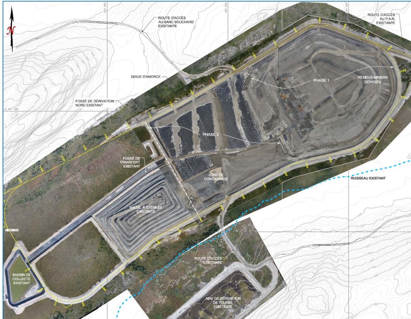
Figure 1-2 : Schéma du parc à résidus
