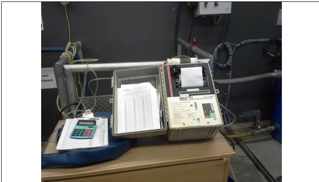
Photo 3 : Vue sur le débitmètre de référence(Avizo) qui mesure la hauteur d'eau au déversoir
