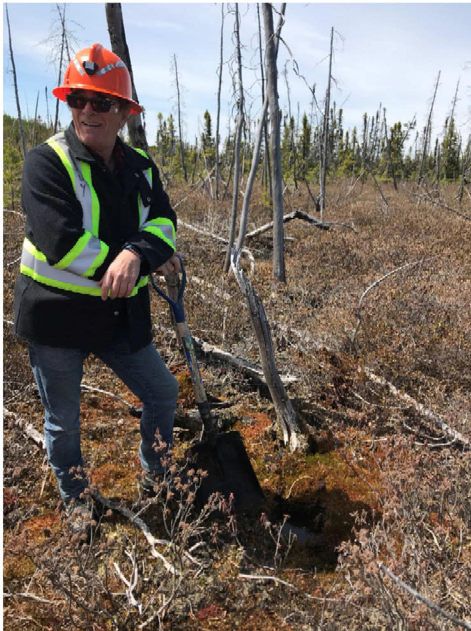
Photographie 4 : Échantillonnage de l'eau dans la tourbière est (proximité des puits d'eau potable)
