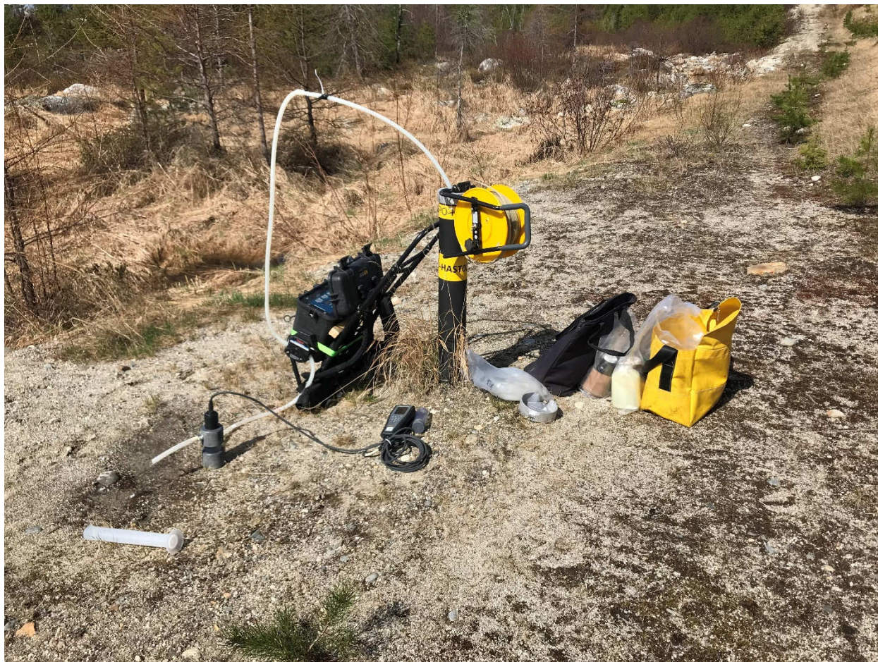
Photographie 1 : Équipement complet pour l'échantillonnage par la méthode faible débit/faible rabattement
