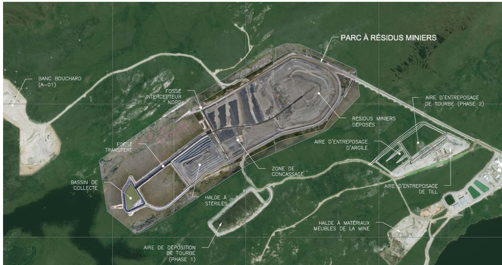
Figure 1-1 : Schéma du parc à résidus et de ses installations
