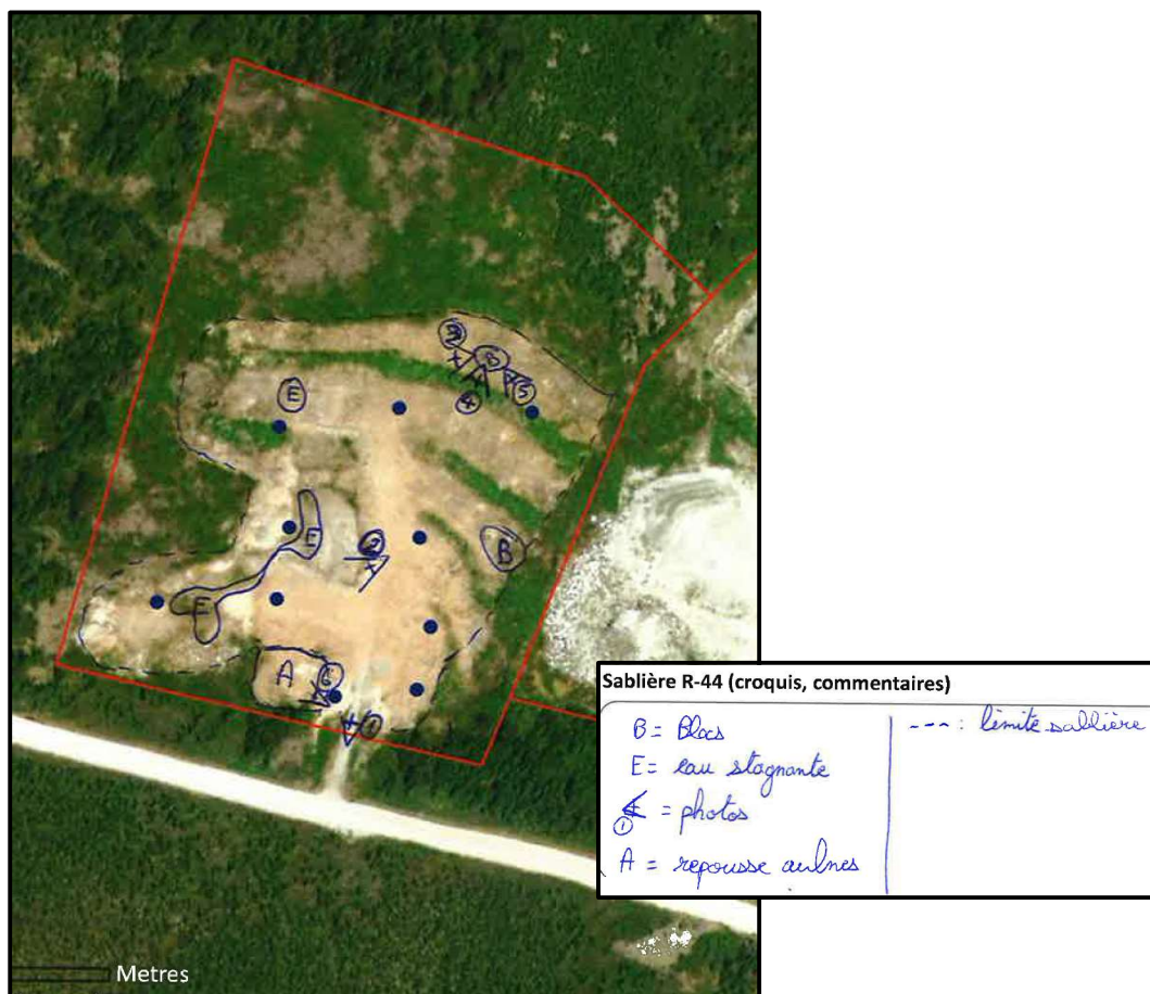
Figure 14: Photo aérienne de la sablière R-44 et résumé des caractéristiques observées (rapport d'échantillonnage sablières, 2020-06-28)
