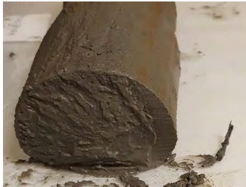
Figure 1 : Exemple d'argile très sableuse (BH-BBA-19-18).
