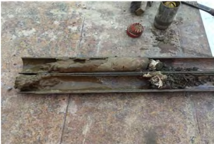
échantillon: CF-05; profondeur: 9' à 11'
