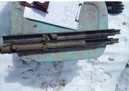
échantillon: CF-02; profondeur: 2.5' à 5'
