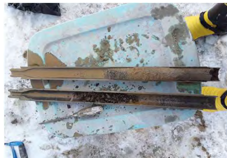
échantillon: CF-09; profondeur: 20' à 22.5'
