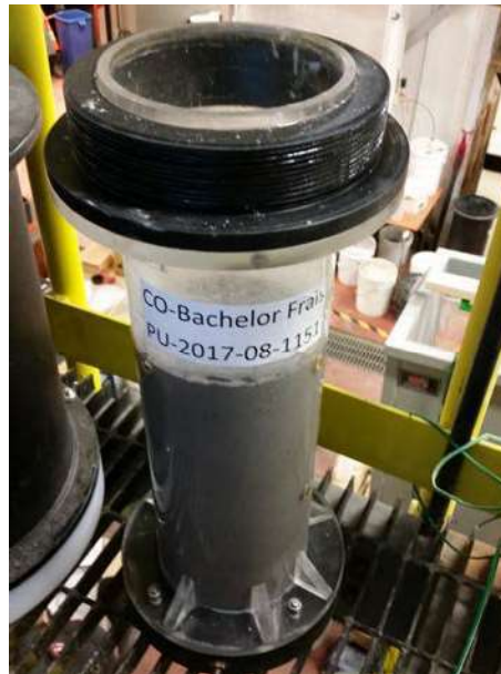
Figure 1 : Essai en colonne sur les Résidus frais
