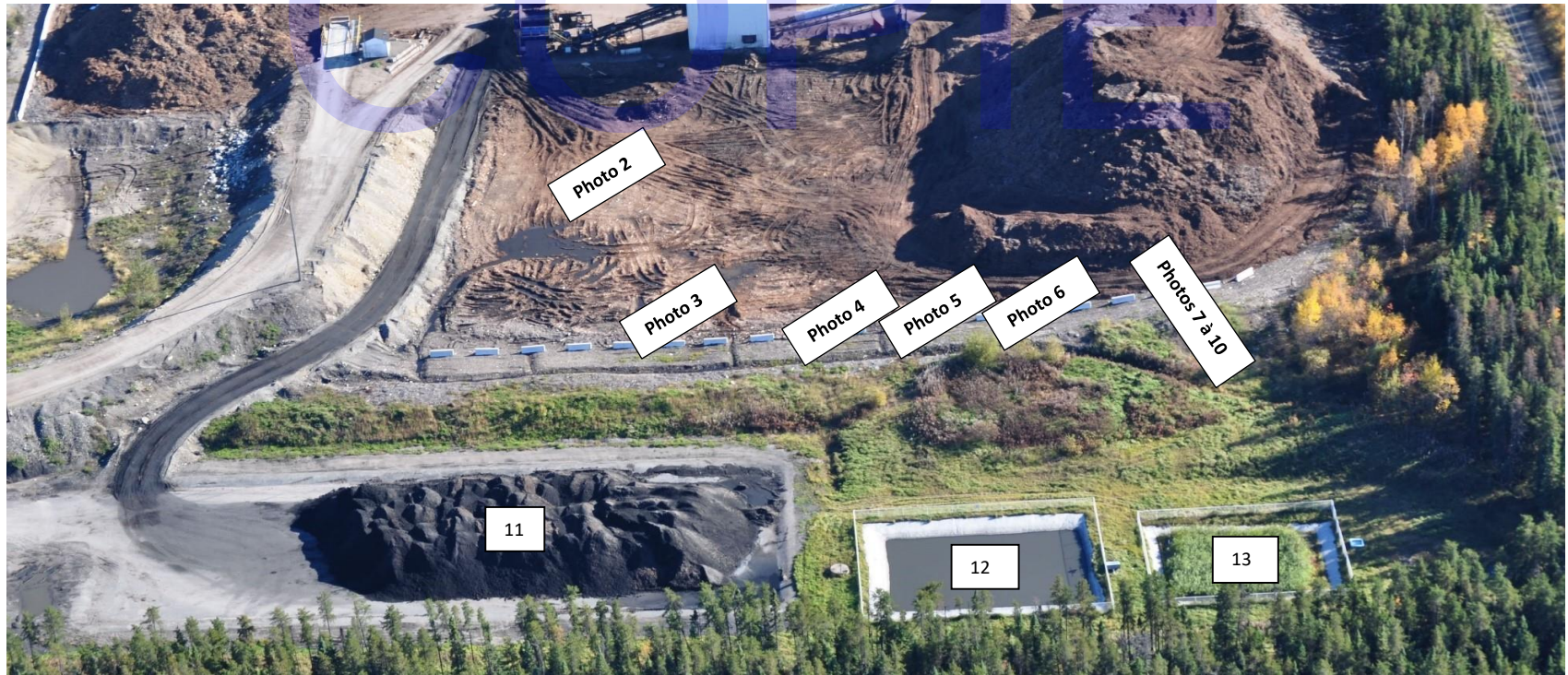
Photo aérienne de CHESEC de 2009 (Photo 1) montrant, de haut en bas, l'aire d'entreposage de la biomasse classifiée* (Photos 2 et 3), le fossé de ruissellement (Photos 4 à 10), l'aire d'entreposage des cendres (11), le bassin de rétention (12) et le Phytoréacteur© (13).
