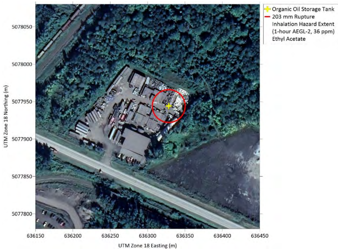
Figure B.11 Scénario pire cas (Rupture de 203 mm du réservoir d'entreposage d'huile organique), Rayon d'impact de risque de toxicité par inhalation (1-heure AEGL-2, 36 ppm), Acétate d'éthyle
