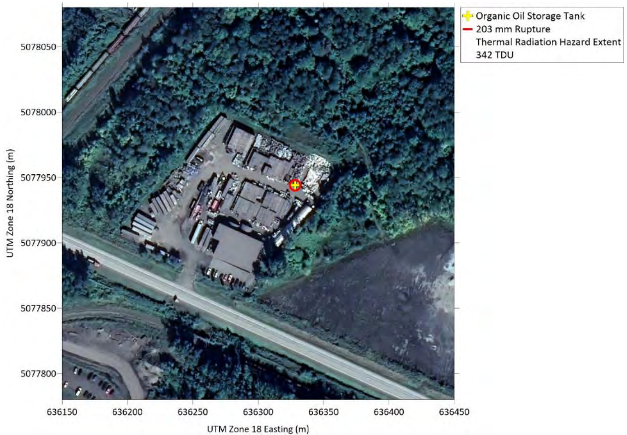
Figure B.20 Scénario pire cas (Rupture de 203 mm du réservoir d'entreposage de l'huile organique), Rayon d'impact de risque de rayonnement thermique (342 UDT). Le scénario alternatif (Rupture de 76 mm) a un rayon d'impact similaire.
