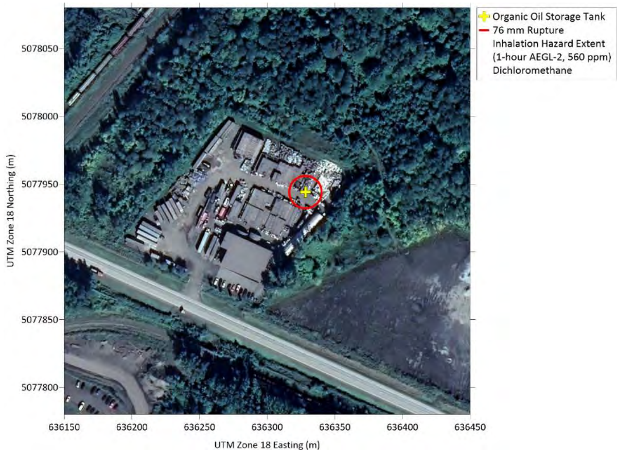
Figure B.10 Scénario alternatif (Rupture de 76 mm du réservoir d'entreposage de l'huile organique), Rayon d'impact de risque de toxicité par inhalation (1-heure AEGL-2, 560 ppm), Dichlorométhane
