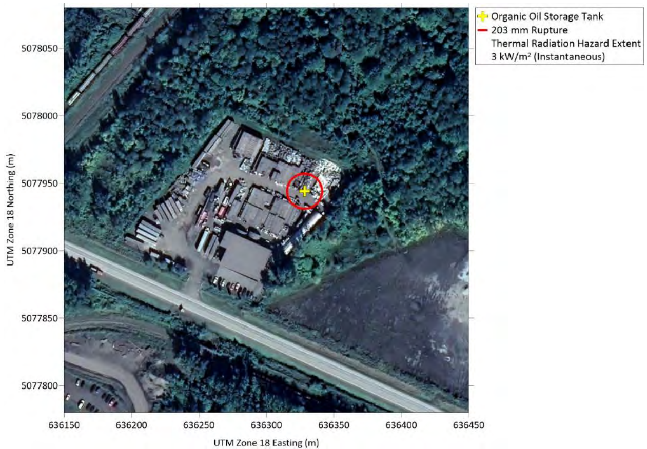
Figure B.14 Scénario pire cas (Rupture de 203 mm du réservoir d'huile organique), Rayon d'impact de risque de rayonnement thermique (3 kW/m 2 ). Le scénario alternatif (Rupture de 76 mm) a un rayon d'impact similaire.
