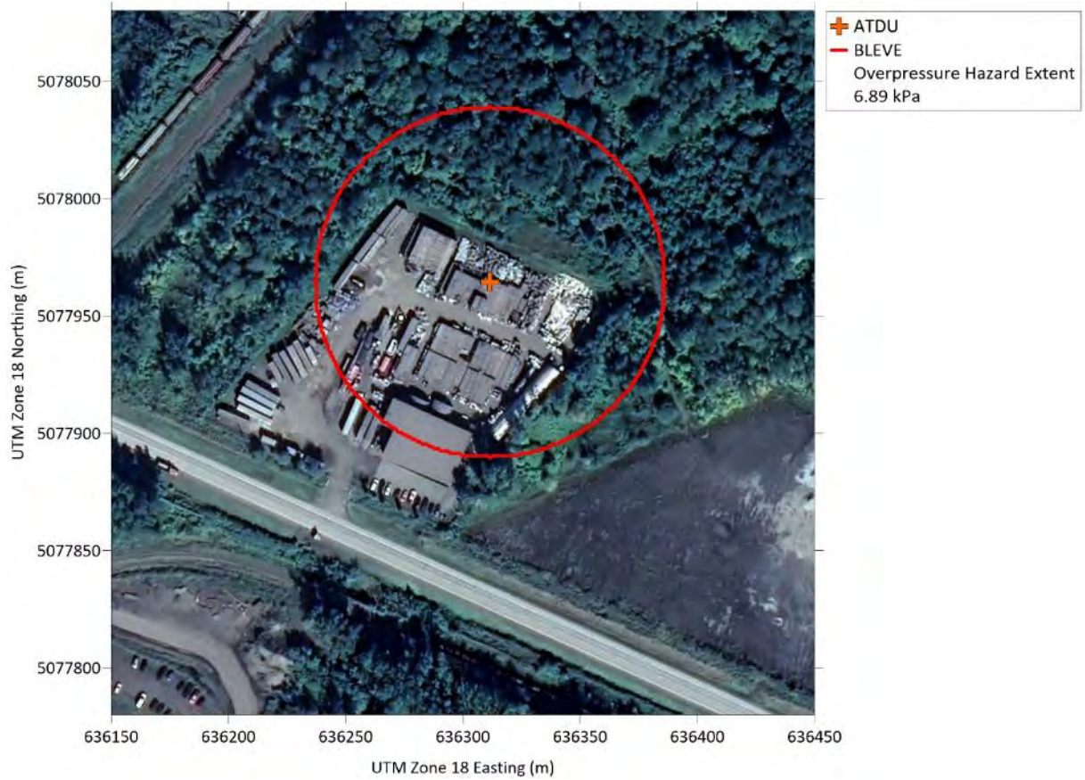
FigureB.21 Incendie à l'intérieur de l'ATDU, Rayon d'impact de risque de surpression (6,89 kPa)
