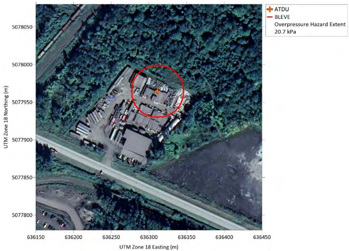
Figure B.22 Incendie à l'intérieur de l'ATDU, Rayon d'impact de risque de surpression (20,7 kPa)
