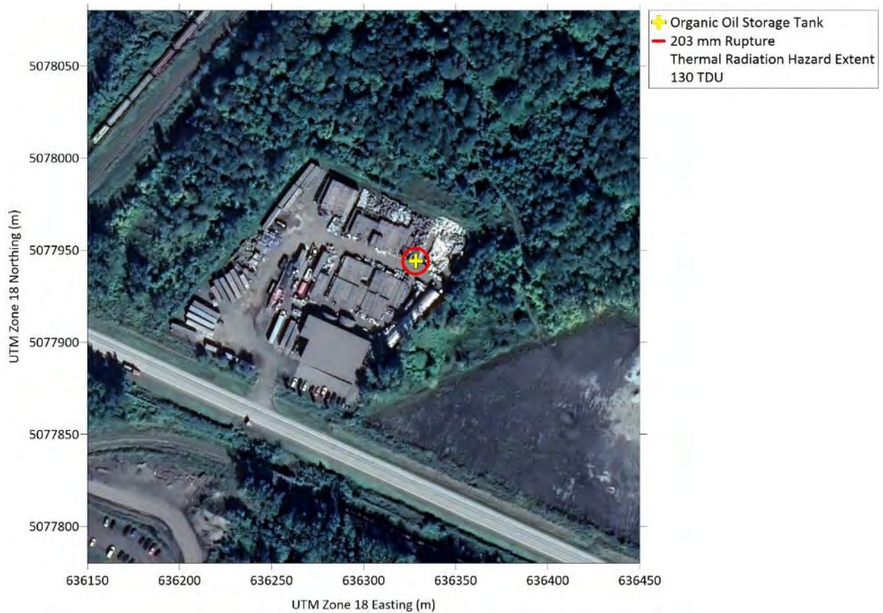
Figure B.19 Scénario pire cas (Rupture de 203 mm du réservoir d'entreposage de l'huile organique), Rayon d'impact de risque de rayonnement thermique (130 UDT). Le scénario alternatif (Rupture de 76 mm) a un rayon d'impact similaire.
