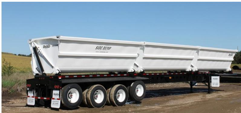
Figure 2 – Remorque à déchargement latéral à quatre essieux
