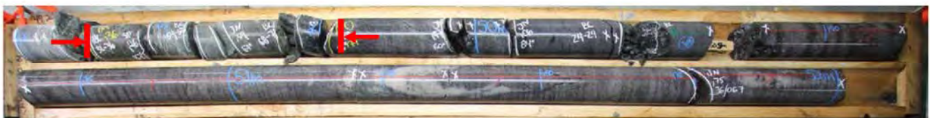
Figure 6: Présence typique d'intrusion mafique dans la carotte (forage CP-ODY-20-01 de 49,36 à 49,77 m)
