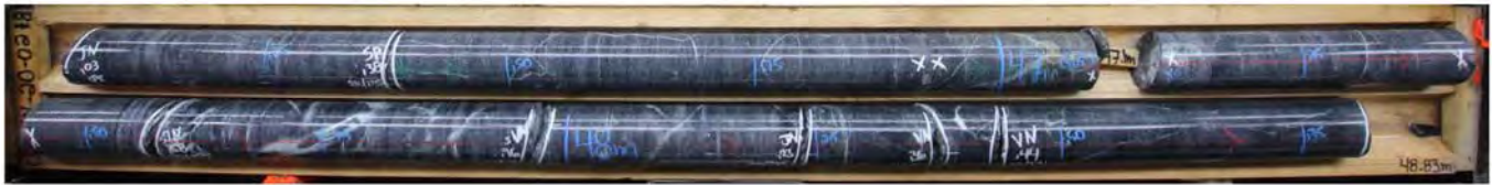
Figure 2: Présence typique d'ultramafique dans la carotte (forage CP-ODY-20-02 de 40,32 à 53,08 m)
