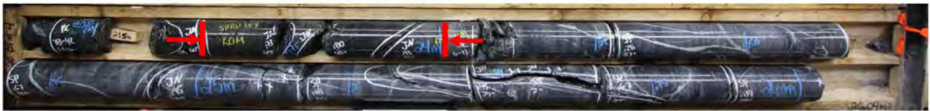
Figure 3: Présence typique de komatiite dans la carotte (forage CP-ODY-20-01 de 23,25 à 24,01 m)
