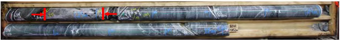
Figure 8: Présence typique d'intrusion felsique dans la carotte (forage CP-ODY-20-02 de 122,75 à 123,02 m)
