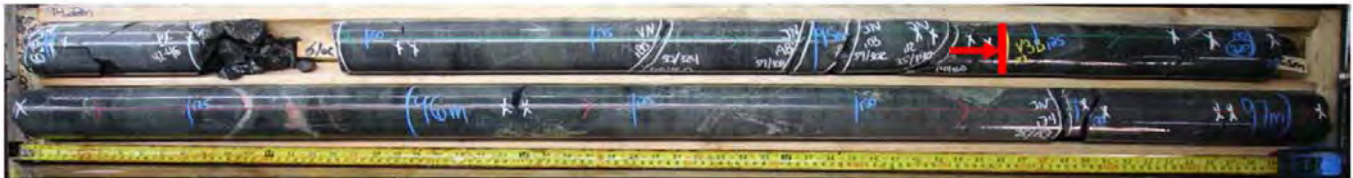
Figure 4: Présence typique de basalte dans la carotte (forage CP-ODY-20-01 de 95,22 à 97,57 m)
