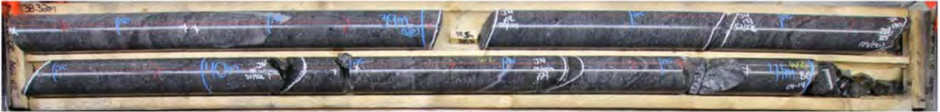
Figure 7: Présence typique de porphyre dans la carotte (forage CP-ODY-20-01 de 36.76 à 41.26 m)
