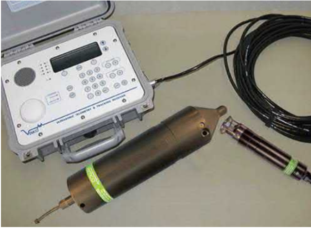
Photo 15. L'hydrophone transpondeur VHTx illustré avec le HR2 et le VR100
