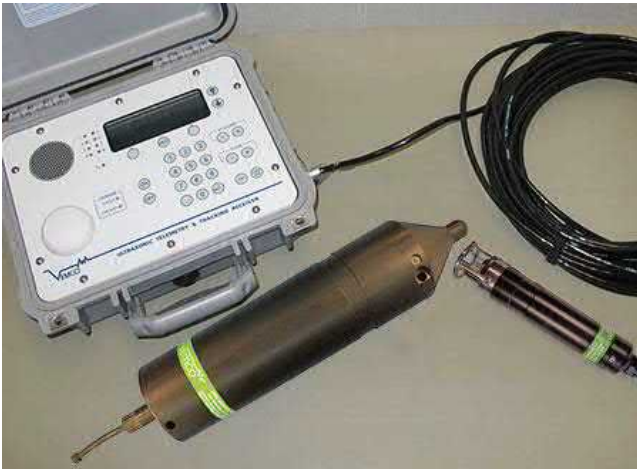
Photo 28. L'hydrophone transpondeur VHTx illustré avec le HR2 et le VR100
