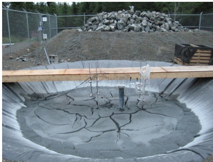
Cellule des résidus en avant-plan, cellule de stérile (dunite serpentinisée) en arrière-plan. Le diamètre des cellules est de 5 m.
