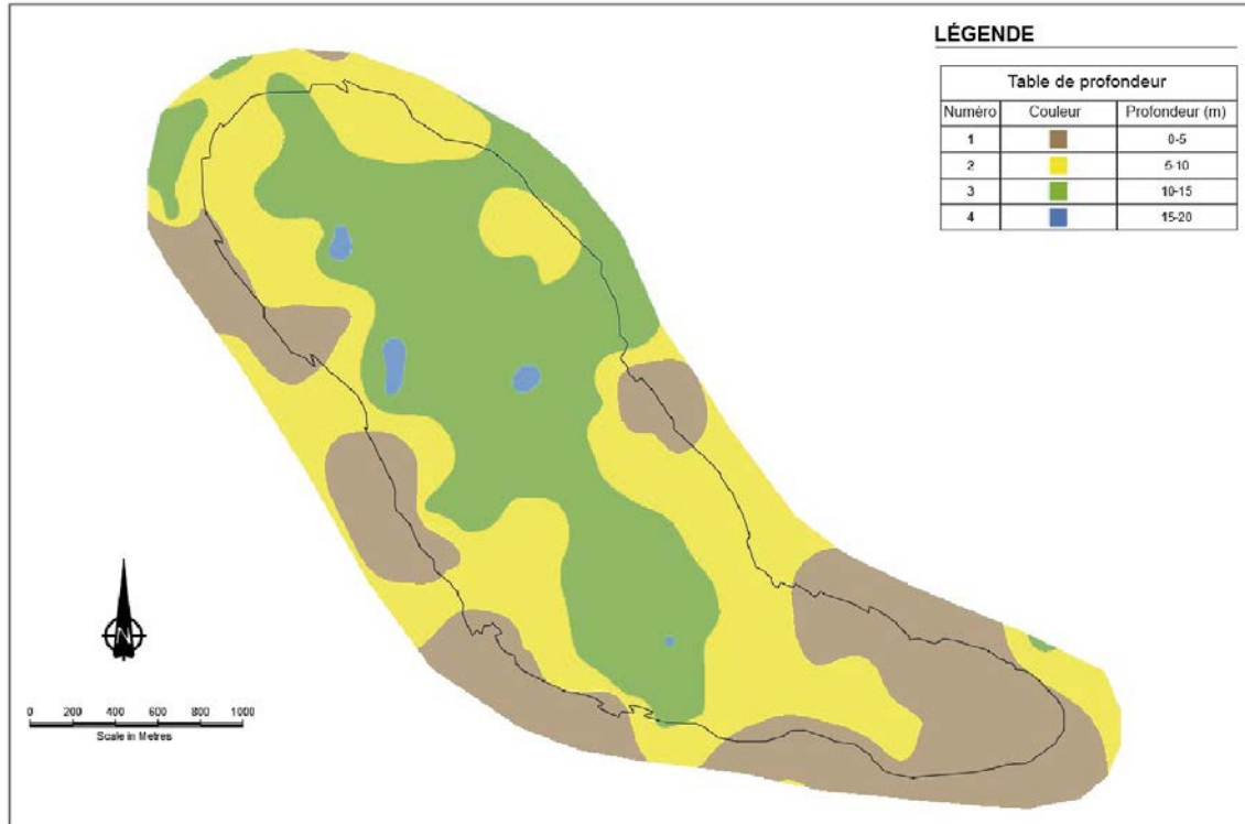
Figure 2-7 : Courbes isopaques montrant l'épaisseur des sols organiques et à grains fins
