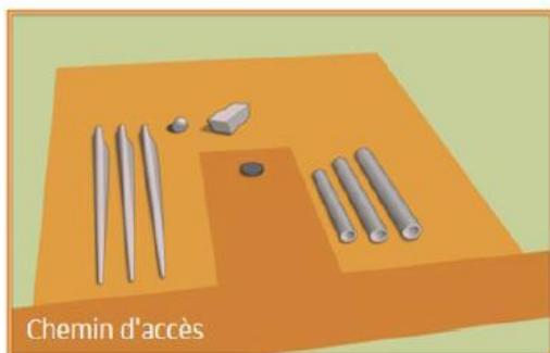
Une zone temporaire d'entreposage d'environ 100 mètres par 100 mètres sera aménagée à l'emplacement de chaque éolienne afin de livrer toutes les pièces requises à l'assemblage de l'éolienne.
