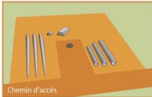
Une zone temporaire d'entreposage d'environ 125 mètres par 125 mètres sera aménagée à l'emplacement de chaque éolienne afin de livrer toutes les pièces requises à l'assemblage de l'éolienne.
