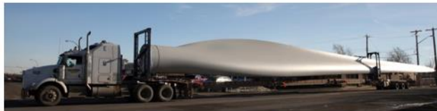
Transport des composants d'une éolienne
