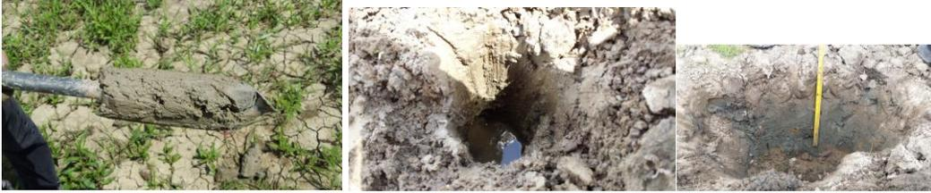
Sur certaines zones (minime), on a pu remarquer, à la base des éoliennes, près des sections de gravier, qu'il y avait encore la présence de couche de gravier à environ 40 cm de profond. À ces endroits, le sol est particulièrement imperméable, ce qui explique une accumulation d'eau dans certains secteurs.
