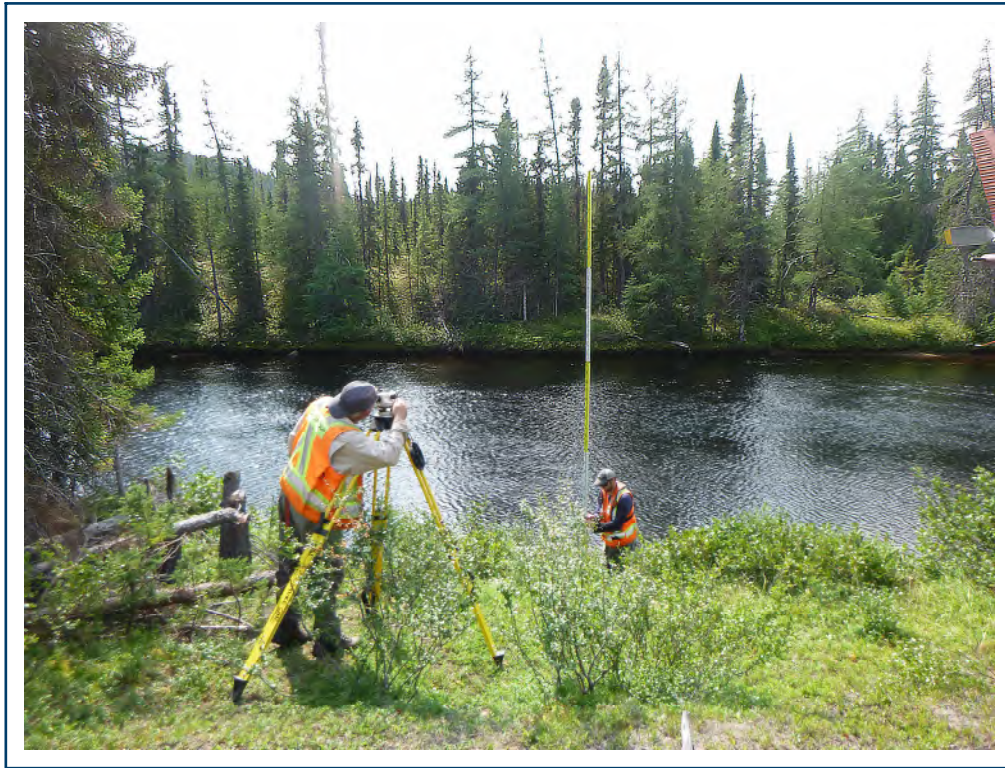
PHOTO 1 — Mesure du niveau d'eau de la Petite rivière Romaine à l'aide d'un niveau optique et d'une règle d'arpenteur, 22 août 2021
