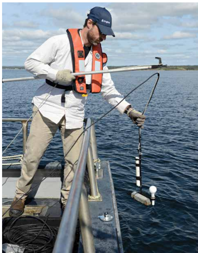
Préparation de la mesure de l'intensité lumineuse dans l'air et dans l'eau jusqu'à une profondeur de 30 m
