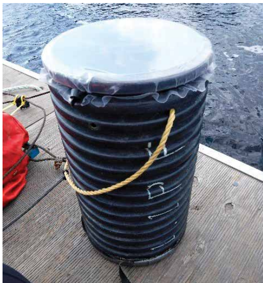
Trappe à sédiments avant son installation dans le substrat de la frayère du PK 34,5 de la Romaine
