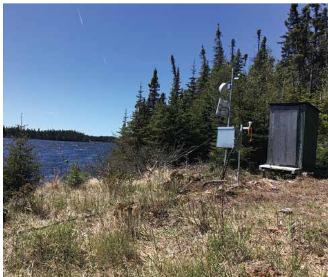
Station hydrométrique avec sonde de température aux abords de la rivière Romaine
