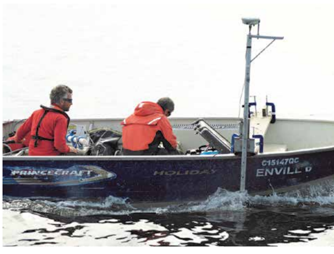
Échosondeur monofaisceau installé dans une embarcation aux fins de relevés bathymétriques de la zone d'étude
