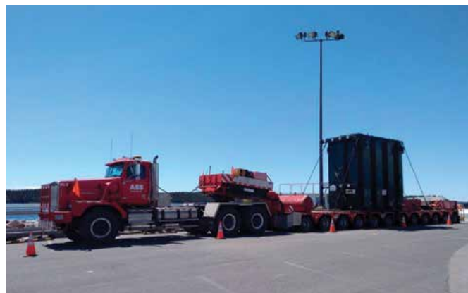
Transformateur au port de Havre-Saint-Pierre en attente de son transport par route jusqu'au chantier de la Romaine-4
