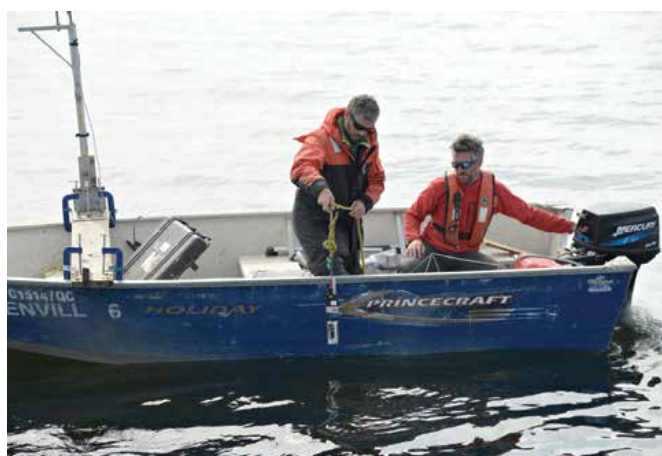
Profilage de la colonne d'eau au regard de la salinité, de la température et d'autres paramètres dans la zone de l'embouchure de la Romaine
