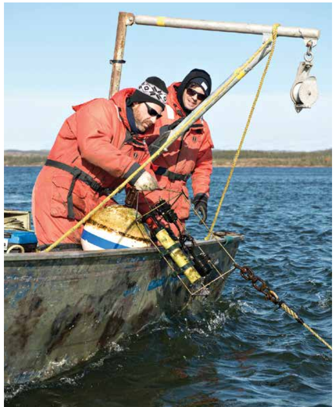
Retrait d'un mouillage servant à mesurer les variations spatiotemporelles de la température de l'eau, de la salinité et de la turbidité dans la zone de l'embouchure de la Romaine
