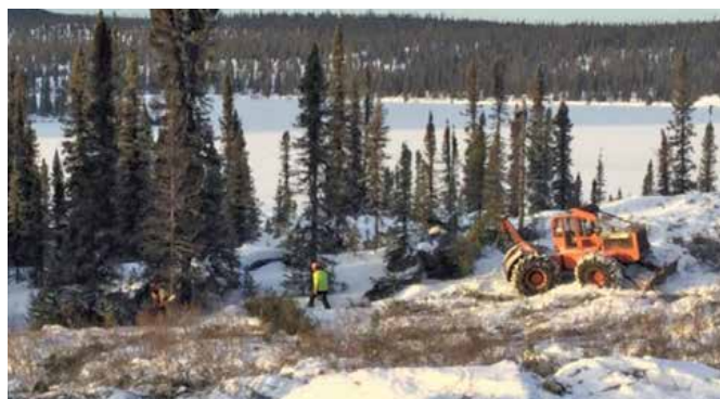
Abattage manuel et retrait des arbres à l'aide d'une débusqueuse munie d'un câble
