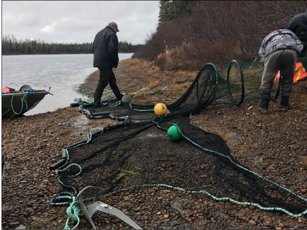
Photo 9 – Aperçu du verveux modifié avec ailes utilisé pour la capture de tacons.
