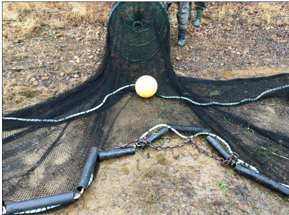
Photo 10 – Aperçu du verveux modifié avec ailes utilisé pour la capture de tacons.
