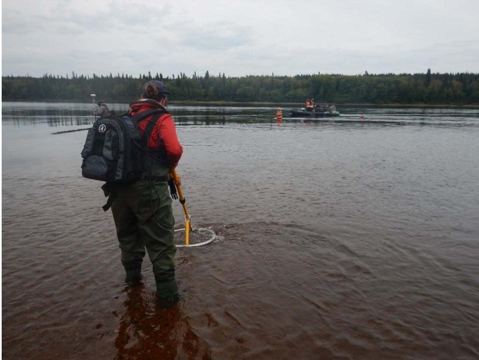
Photo 3 Détection des transpondeurs passifs dans l'embouchure du tributaire au PK 46 de la rivière Romaine
