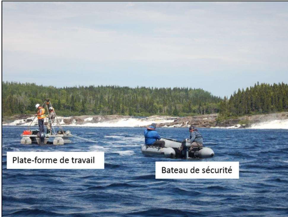
Photo 4 Ponton de 16 pieds qui a servi de plate-forme de travail et bateau de sécurité pour le carottage de la frayère naturelle au PK 34 de la rivière Romaine.
