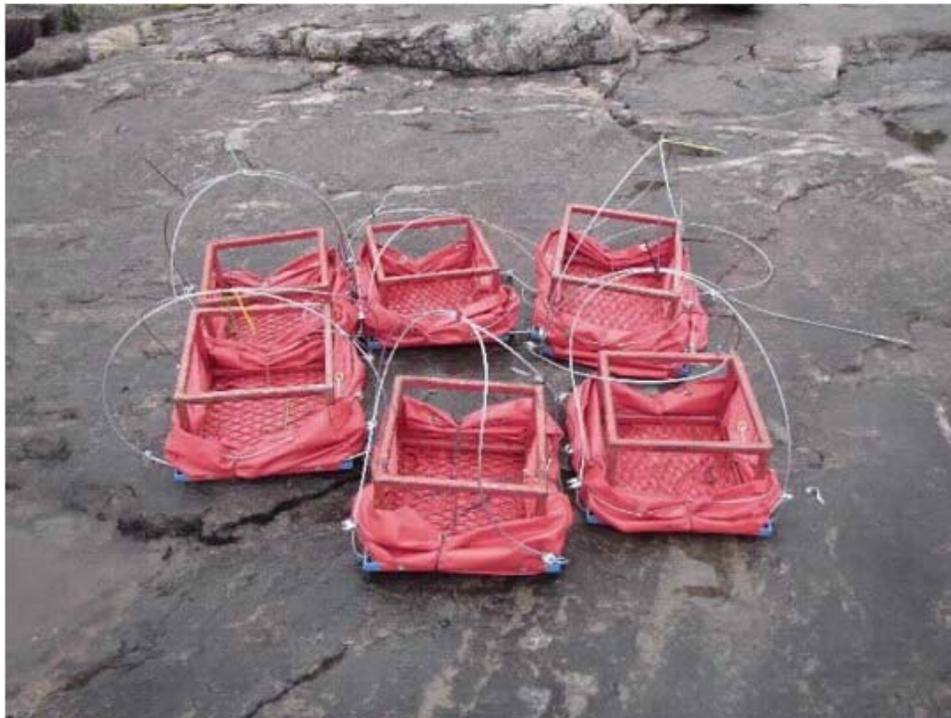
Photo 6 Cubes d'infiltration avant leur installation dans le substrat des frayères de la rivière Romaine
