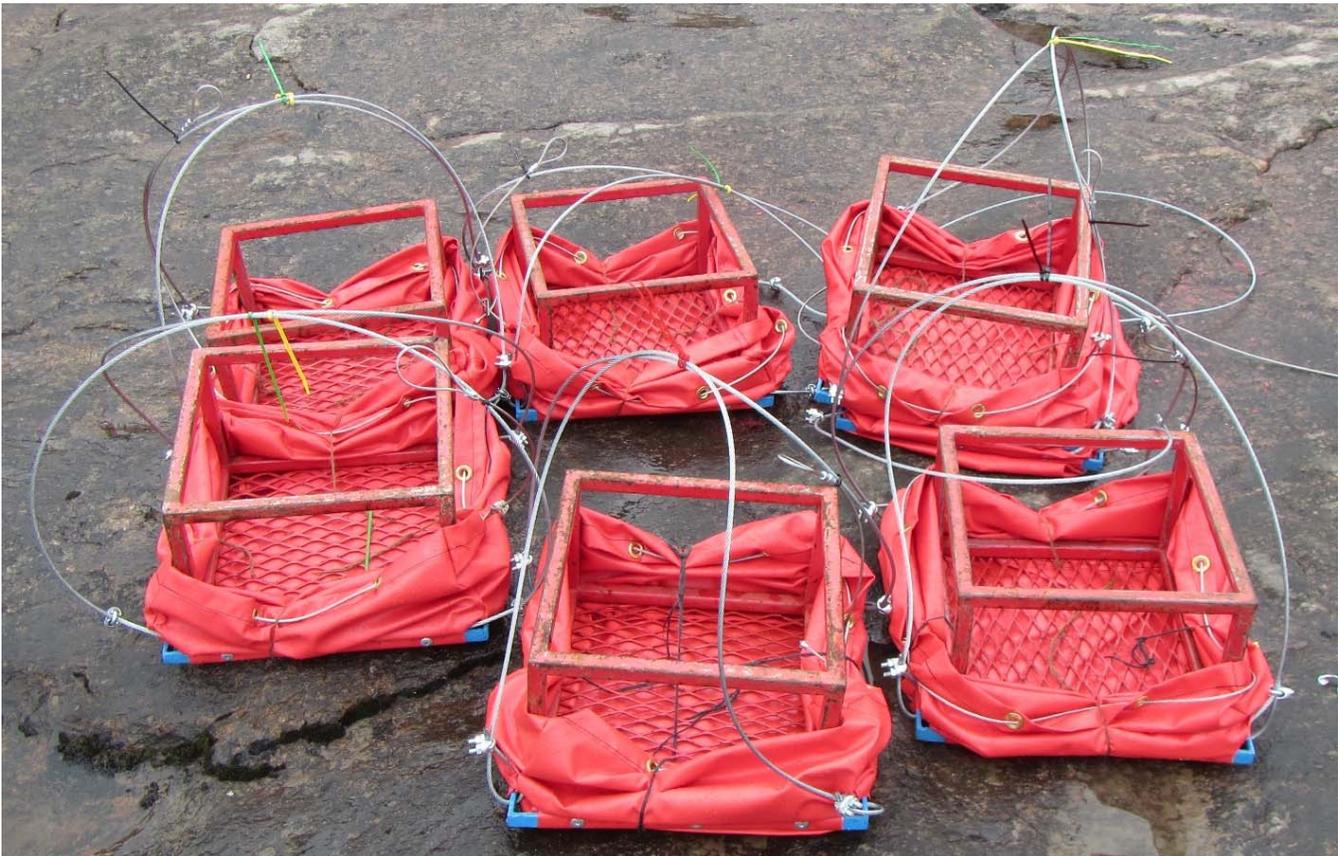
**Figure 4-4** Cubes d'infiltrations avec leur sac d'échantillonnage partiellement replié vers le bas avant l'installation.
