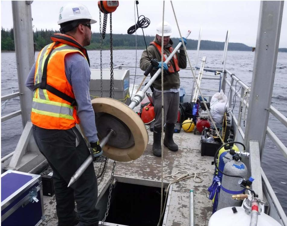
Photo 5 Installation du carottier cryogénique à travers le trou central du ponton de 16 pieds
